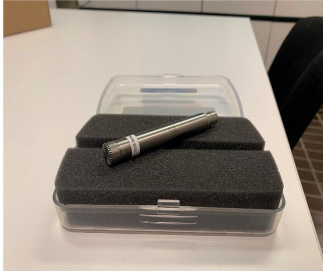
*Figura 81, Microfono PCB Piezotronics*
