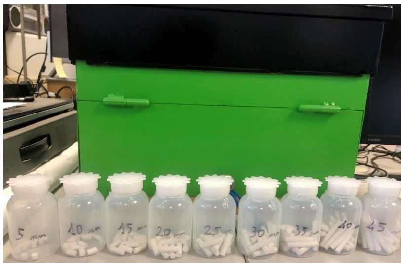
Figura 3.8: “Pellet” in PVC suddivisi per classi di lunghezza.
