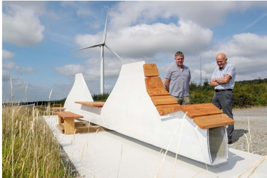
Figura 4.18 Pala eolica utilizzata per realizzare panchine e tavolo per picnic situate all'interno del parco eolico di Meenadreen (Irlanda)
