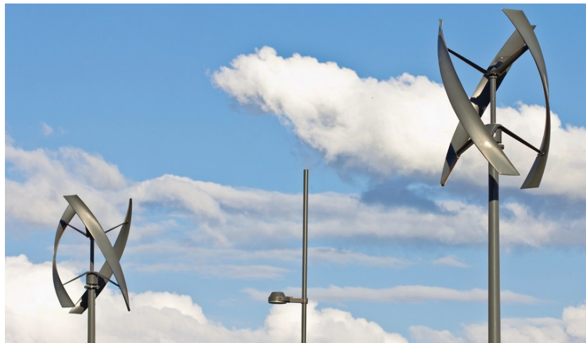
Figura 1.7 Turbina eolica ad asse verticale
