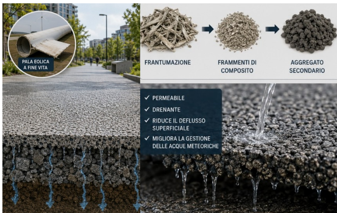
Figura 4.4 Processo di creazione di un pavimento drenante
