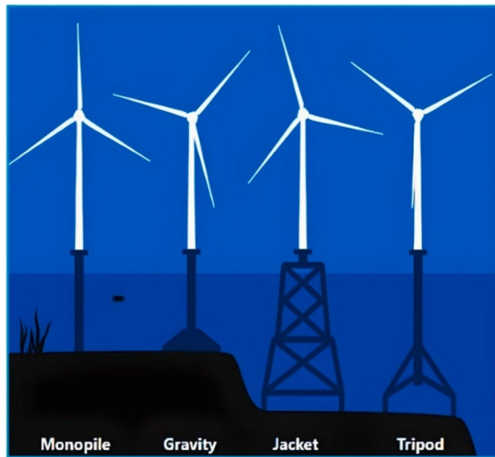
Figura 1.4 Fondazioni fisse per turbine eoliche offshore
