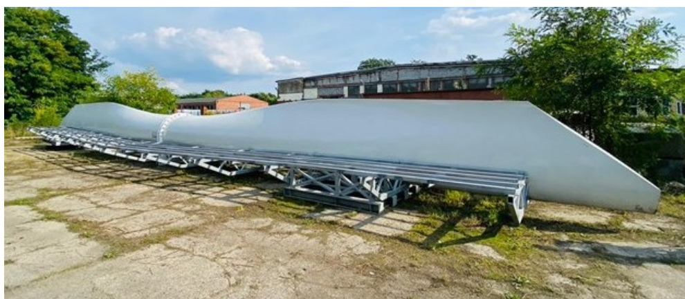
Figura 4.22 Pala eolica che verrà utilizzata come trave portante principale
