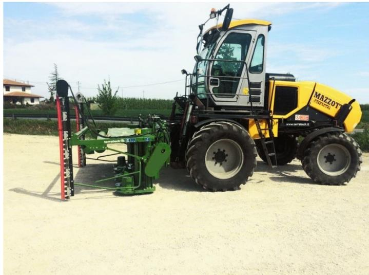
Figura 16 Falciandatrice Mazzotti con testata a dischi. (Fonte: [www.terratech.it](http://www.terratech.it)).
