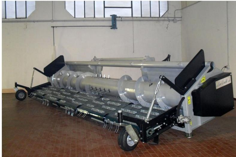
Figura 18 Testata pick-up per mietitrebbia prodotta dalla ditta MecDall (Fonte: [www.mecdall.it](http://www.mecdall.it)).
