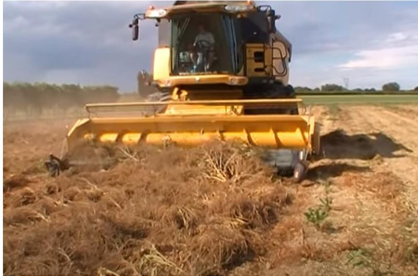
Figura 21 Trebbiatura bietola da seme con pick-up. (Fonte: [www.terratech.it](http://www.terratech.it))
