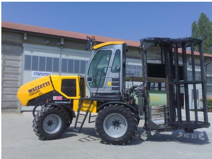
Figura 17 Falcianatrice Mazzotti con testata classica con sistema di convogliamento misto. (Fonte: [www.terratech.it](http://www.terratech.it)).
