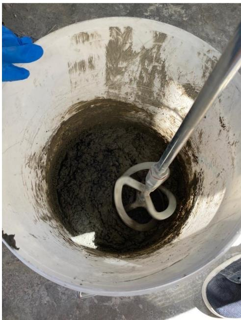
*Figura 20 – Miscelazione con miscelatore elettrico della miscela RIF*
