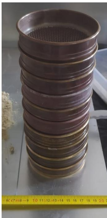
*Figura 18 – Setacci in serie usati per determinare la curva granulometrica del LCD trattato secco*
