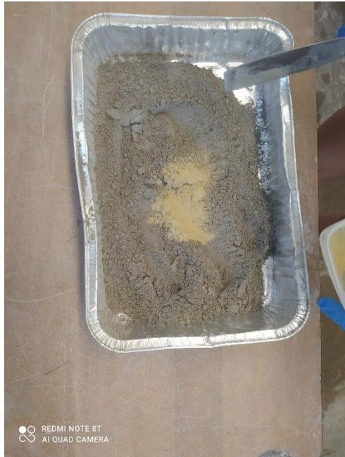
*Figura 23 – Miscelazione LCD 4% fine con cemento*
