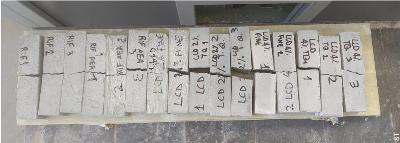
Figura 30 – Provini rotti in seguito alla prova a flessione
