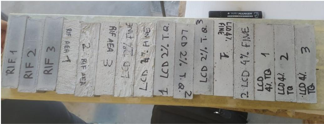
Figura 27 – Provini da sottoporre alla prova di flessione
