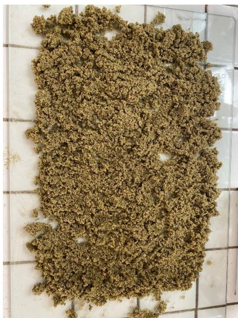
*Figura 17 – LCD ( $<1$  mm) umido dopo lisciviazione e lavaggi*
