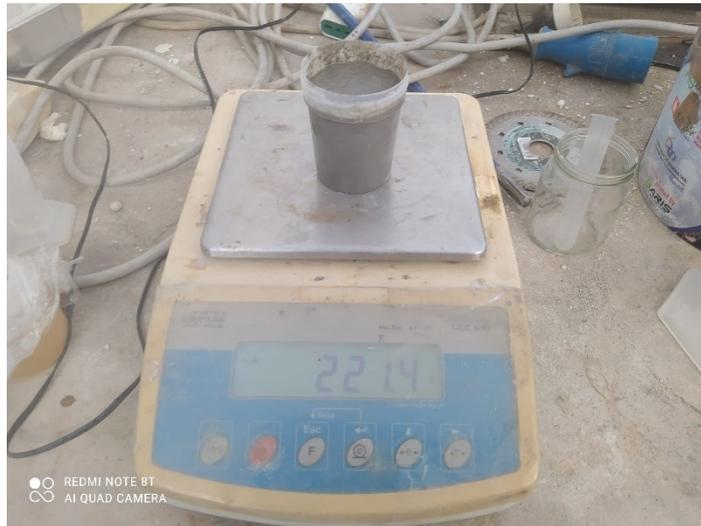
*Figura 26 – Pesatura della malta fresca per calcolarne la densità*
