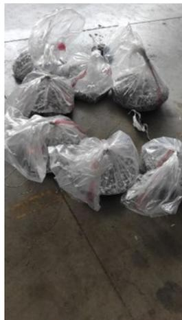
*Figura 3 – Sacchi di LCD macinato forniti dall'impianto di trattamento RIMEL*
