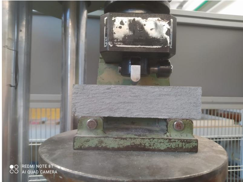
*Figura 29 – Prova di rottura a flessione*
