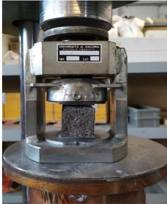
*Figura 31 – Prova di rottura a compressione*
