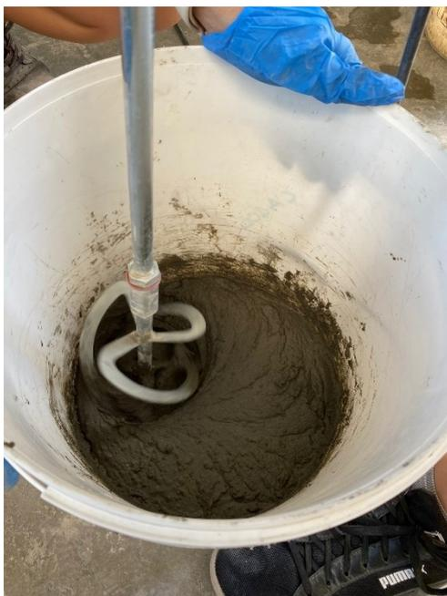
*Figura 22 – Miscelazione con miscelatore elettrico della miscela RIF AEA*
