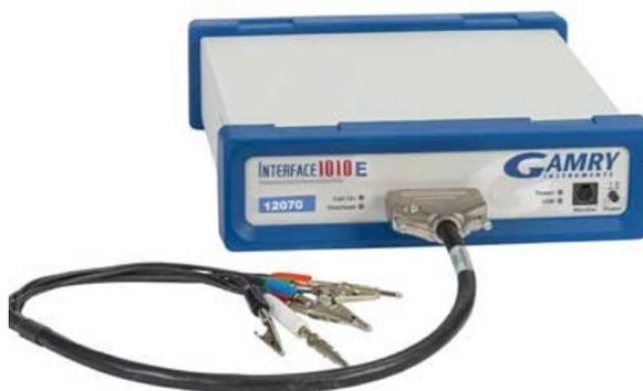
**Fig. 2.6:** potenziostato Gamry Interface 1010E utilizzato per svolgere le analisi potenziodinamiche cicliche.
