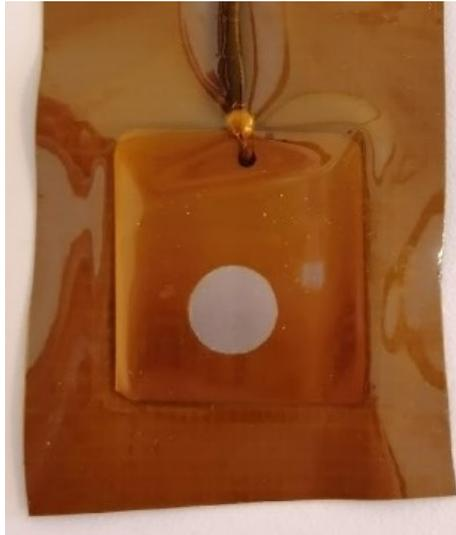
**Fig. 2.3:** campione collegato tramite contatto elettrico con un cavo da collegare al potenziostato e coperto con nastro isolante protettivo Kapton che lascia esposta un'area standard di esame di 1,23 cm<sup>2</sup>.
