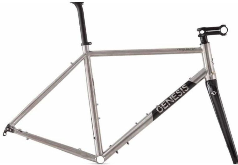
Figura 1.2: telaio in titanio di una bici da corsa
