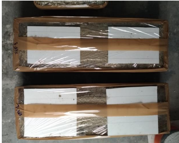
Fig. 3. 6 Provini avvolti da pellicola prima dell'inserimento nella camera
