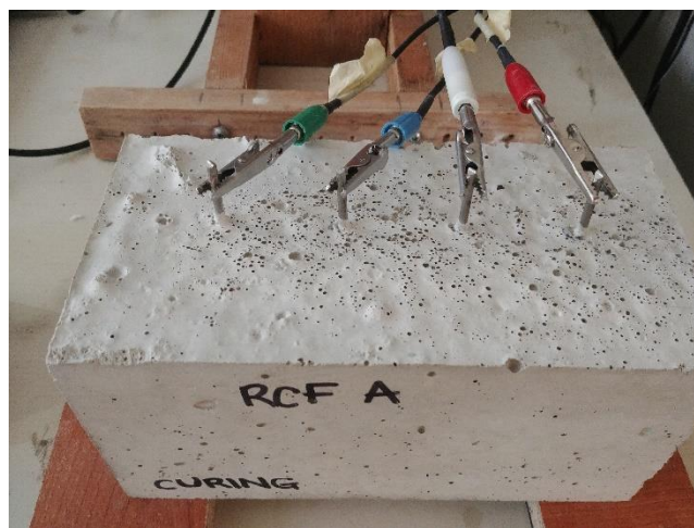
Fig. 3. 5 Esempio di collegamento elettrodi al provino
