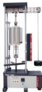
Figura 3.2: Macchina per prova creep (Fonte: catalogo zwickroel.com)
