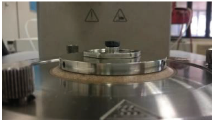
Figura 49 Posizionamento del provino sul piatto inferiore.
