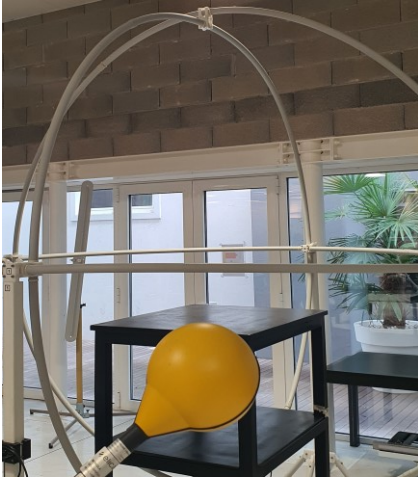
Figura 11 - Antenna loop per la misura della potenza irradiata
