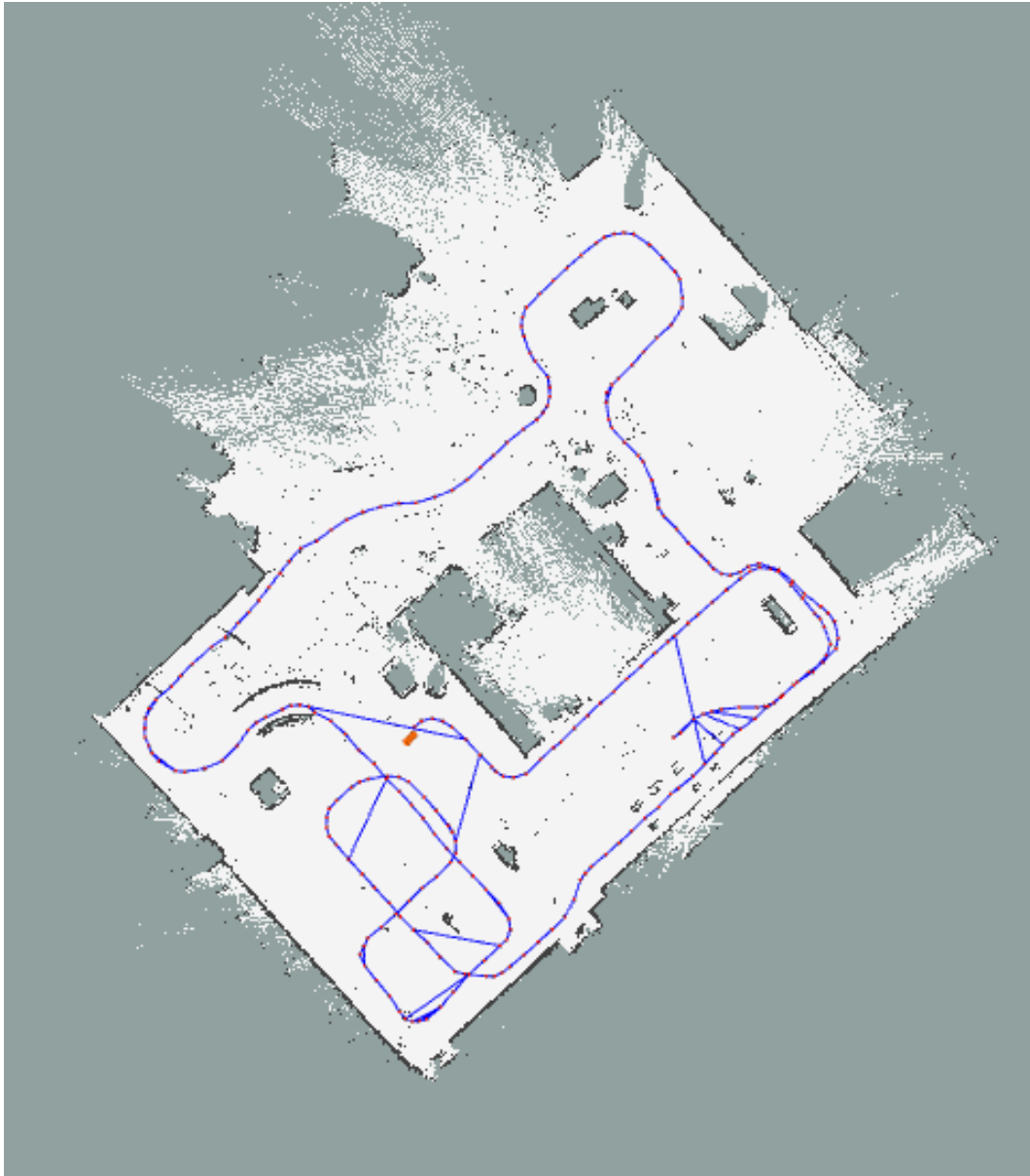
Figura 8.2.: Mappa di occupazione generata presso il Bosch Engineering Center, con evidenza delle pose e dei vincoli probabilistici.
