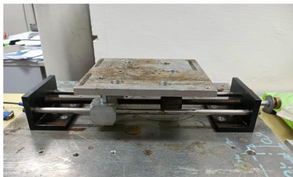
Figura 7.5. Sistema di movimentazione vite-madrevite.
