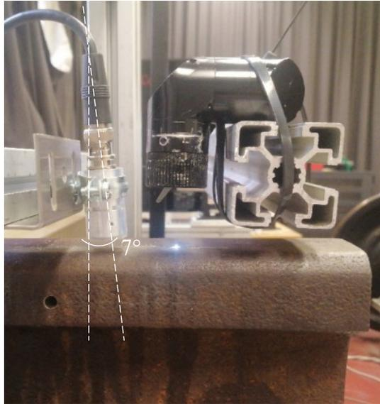
Figura 7.17. Configurazione di misura con sonda inclinata di  $7^\circ$ .
