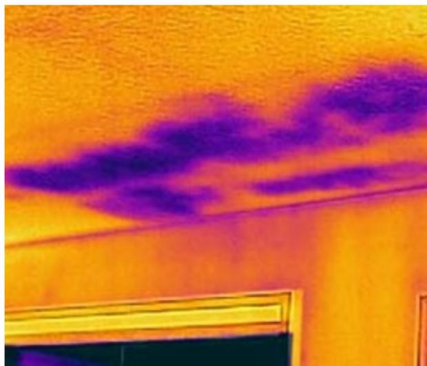
Figura 1.2. Esempio applicativo della termografia in campo edile con rilevazione di infiltrazioni di umidità.
