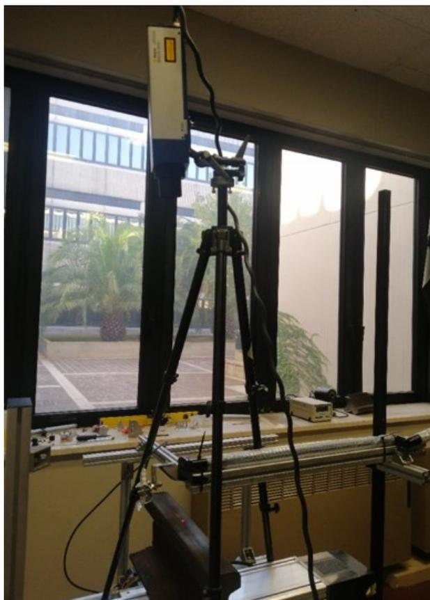
Figura 7.30. Configurazione di misura con interferometro laser.
