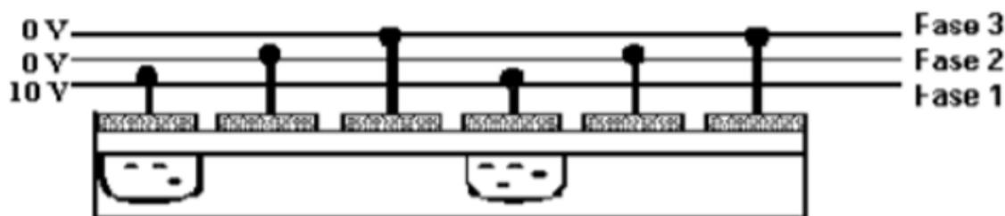
Figura 3.12. Rappresentazione schematica di un pixel del sensore CCD, dove la tensione è applicata solo agli elettrodi della fase 1.
