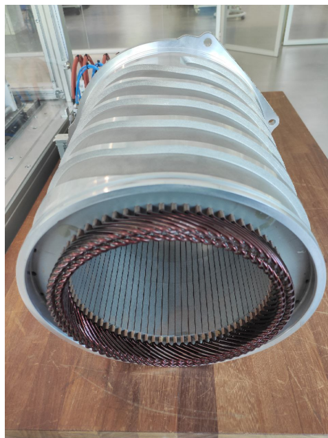
Figura 1.2: Statore realizzato in tecnologia hairpin
