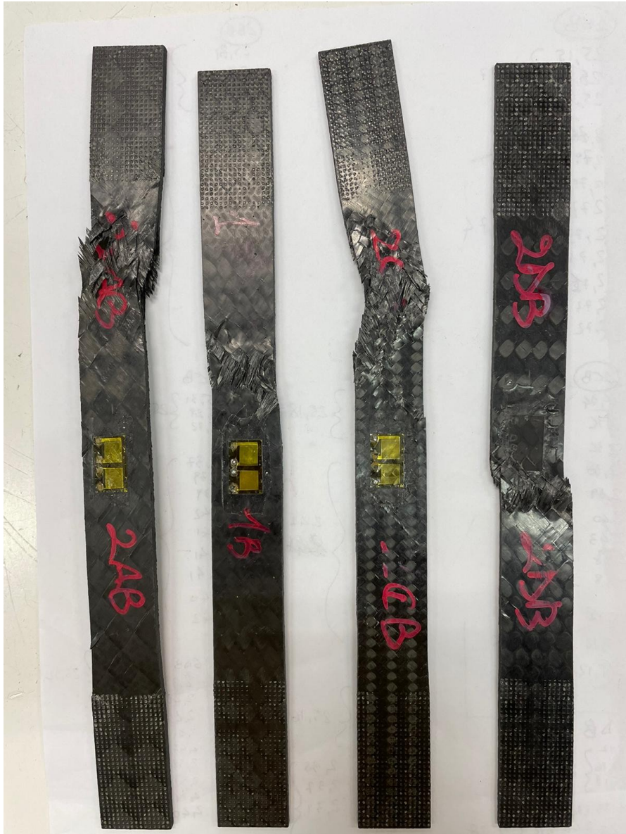
Fig. 36 deformazione ai provini a seguito della prova meccanica che simula il comportamento a flessione
