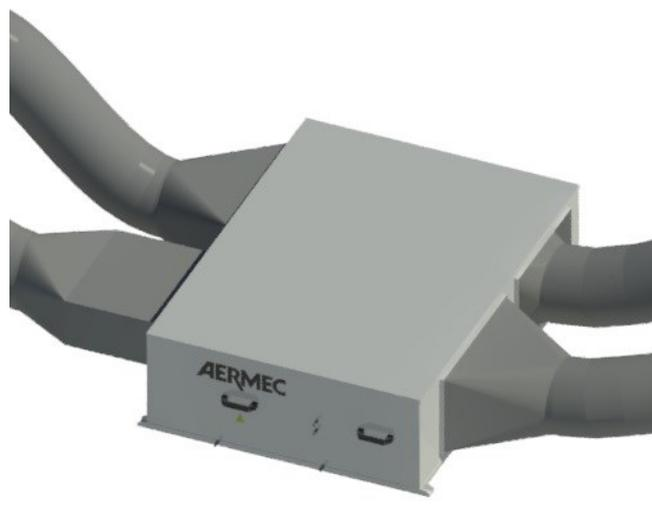
Figura 3.4: dettaglio del recuperatore dal modello di Revit (raytrace)
