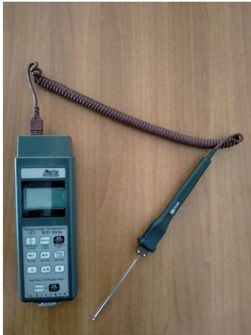
Figura 3.24: termocoppia Delta Ohm 9016
