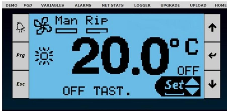
Figura 4.2: display con la temperatura di Set-Point
