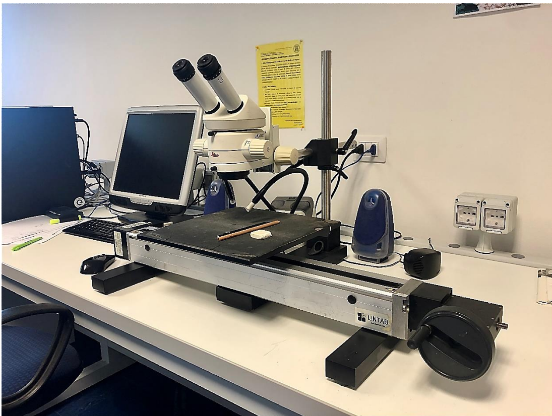
Fig. 2.3.1.1- Postazione di misurazione anelli legnosi con sistema LINTAB presso il TreeringLab-UNIVPM
