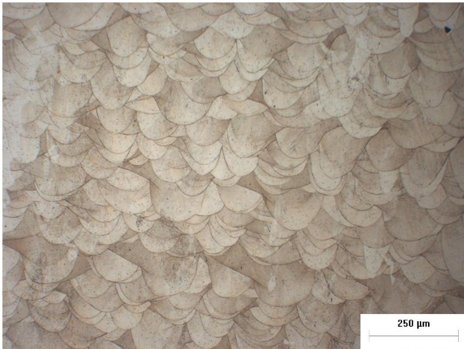
Figura 58. Immagine al MO sul piano YZ con ingrandimento 10x0,8.
