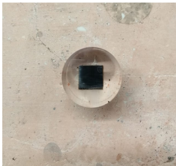
Figura 38. Campione DR inglobato con resina trasparente.
