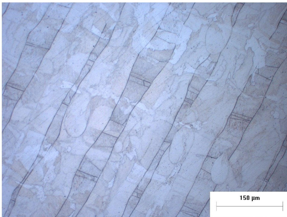
Figura 56. Immagine al MO sul piano XY con ingrandimento 20x0,8.
