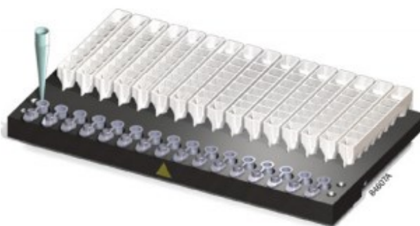
Figura 30 Supporto magnetico del Maxwell® 16 con cartucce ready to use ed elution tubes del kit DNA IQ™ Casework Pro Kit. Il puntale indica l'aggiunta di Elution Buffer.
