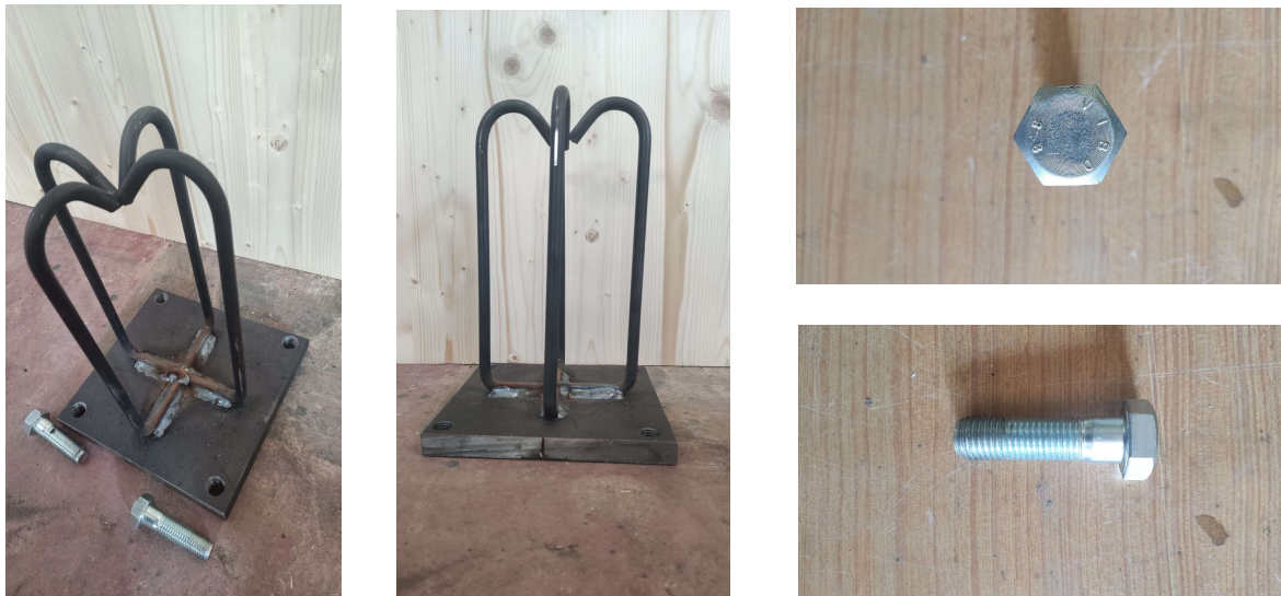
Figura 3.27 – Piastra e tirafondi utilizzati per fissare il telaio in calcestruzzo armato alla struttura in acciaio
