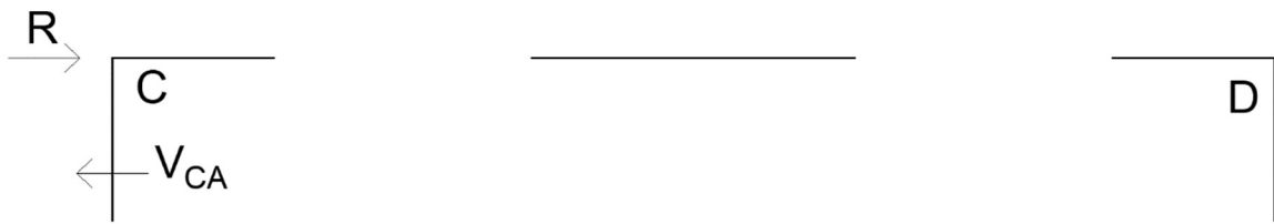
Figura 3.10 – Calcolo della reazione vincolare del carrello nello schema \Phi_C
