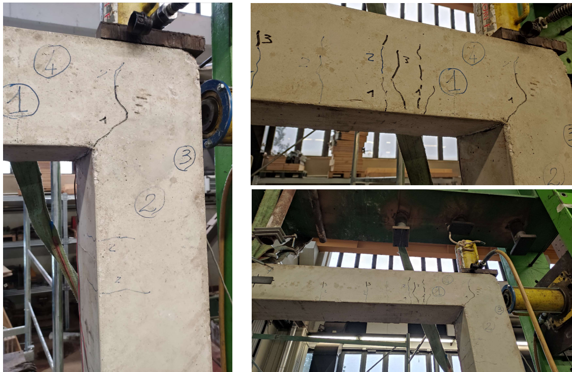
Figura 3.29 – Fessurazione del calcestruzzo dopo la prima prova sperimentale
