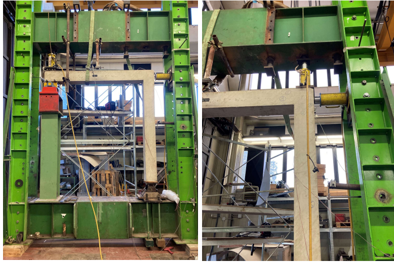
Figura 3.26 – Struttura in acciaio utilizzata per effettuare la sperimentazione
