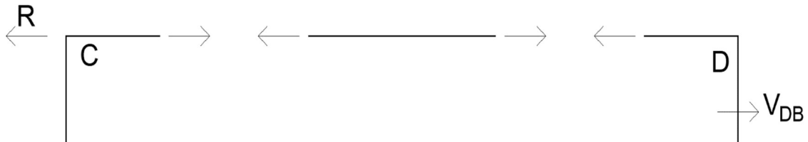
Figura 3.12 – Calcolo della reazione vincolare del carrello nello schema \Phi_D
