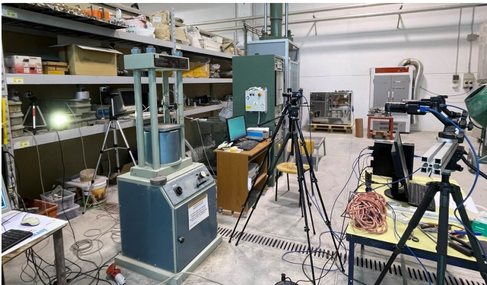
Figura 9 Pressa utilizzata per la prova a compressione con set-up di telecamere
