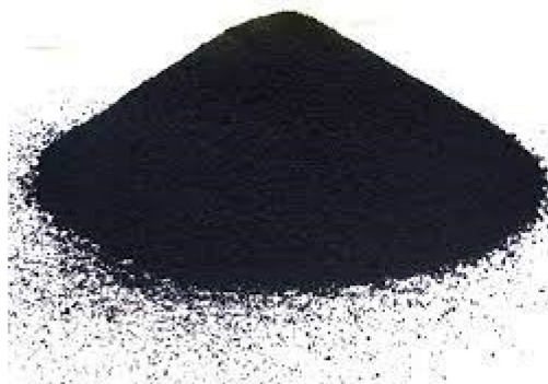
Figura 2.2 – Carbon crack, fase di rinforzo nelle produzioni della gomma per pneumatici
