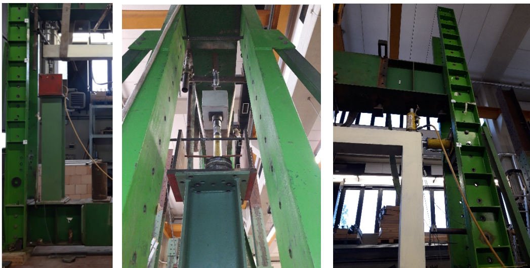
Figura 3.10 – Martinetti verticali ed orizzontali utilizzati per l'applicazione dei carichi o come vincolo
