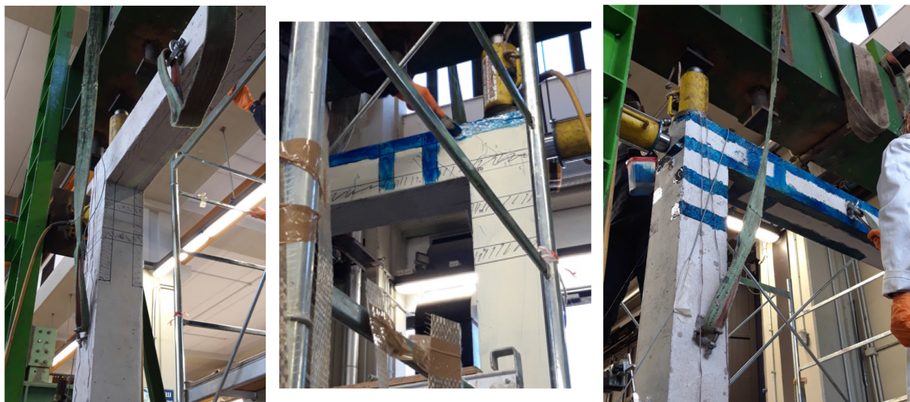
Figura 3.20 – Applicazione della matrice adesiva
