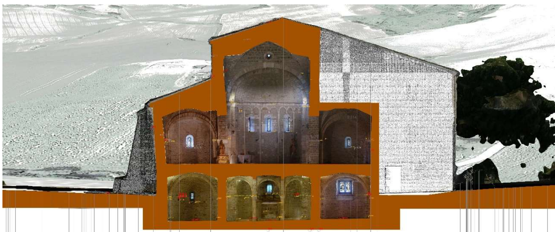
Figura n° 9.6.4: sezione trasversale vista est, taglio nella parte finale del presbiterio e della cripta.
