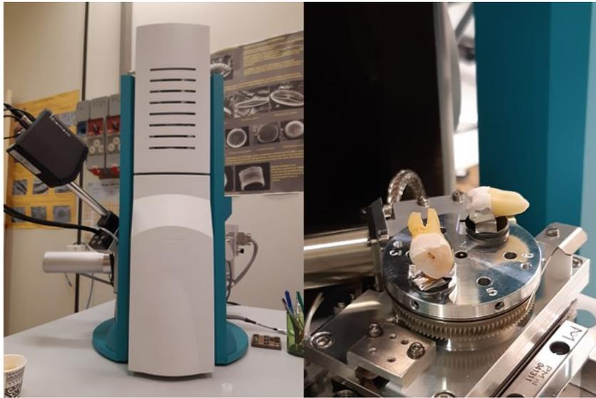
**Figura 6.** Immagine che mostra il Microscopio Elettronico a Scansione (SEM) e il montaggio dei campioni.
