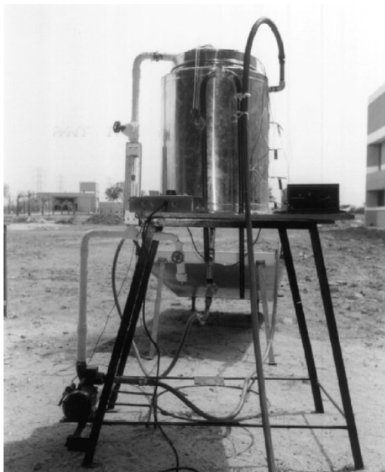
Figura 27: Vista fotografica configurazione sperimentale che combina l'uso di SHTES e LHTES (97).
