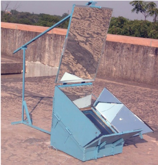
Figura 7: Forno solare a scatola, modificato con uno specchio per aumentare la radiazione solare accumulata (21)
