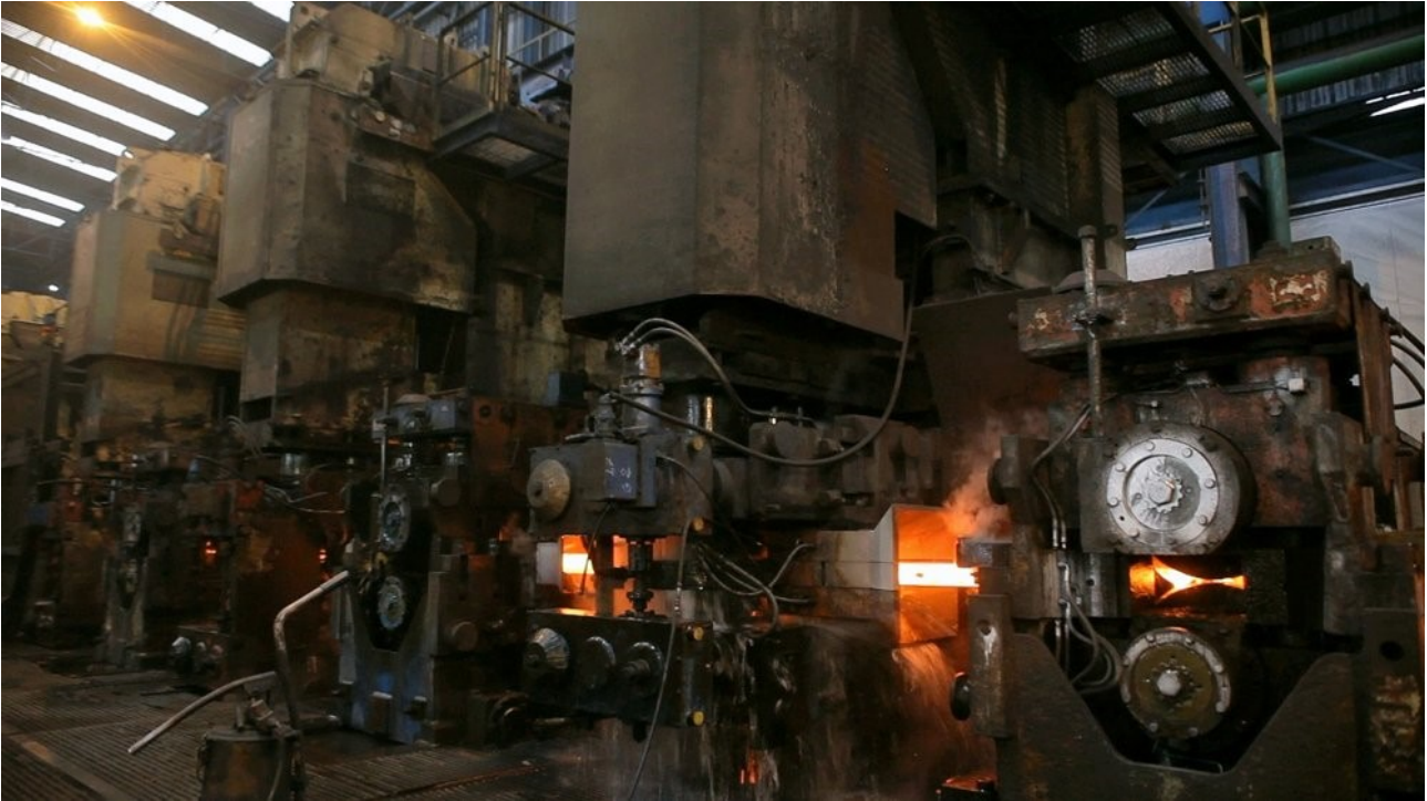
Figura 6 Treno di laminazione https://www.alfacciai.it/uploads/2018-11-16/1000-0/alfa-acciai-processi-laminazione-a-caldo-21.jpg.jpg
