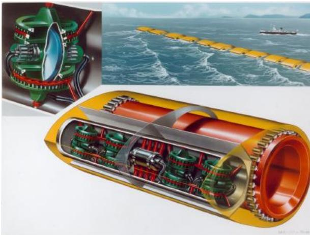
*Fig.1.16 rappresentazione del galleggiante utilizzato nel dispositivo Slater's Duck e collegamento di numerosi dispositivi di questo tipo lungo una spina. (Babarit, A. (2017). Ocean Wave Energy Conversion. Elsevier)*
