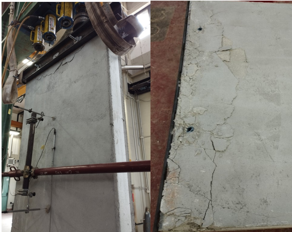
Figura 49 - Rottura per schiacciamento del cordolo superiore E3
