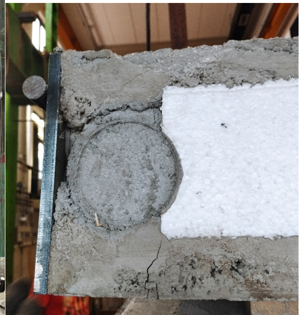
Figura 48 - Rottura per schiacciamento del cordolo superiore E2
