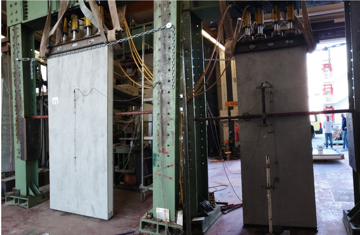
Figura 31 - Setup della prova frontale (a), setup della prova retro(b)
