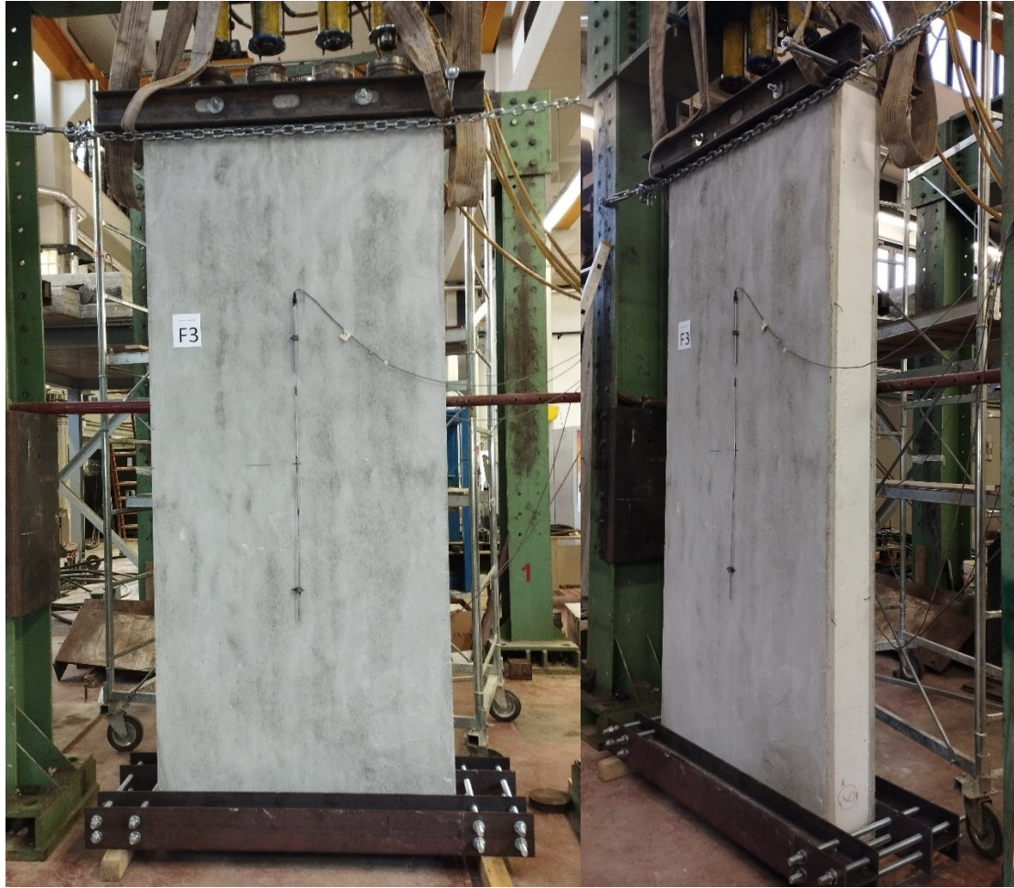
Figura 50 - Rottura per schiacciamento del cordolo superiore F3
