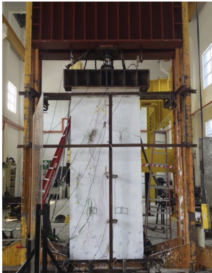
Figura 11 - Configurazione del telaio per la prova di compressione
