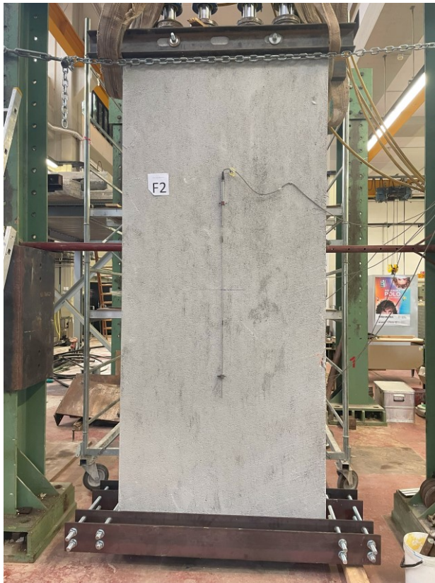
Figura 47 - Rottura per schiacciamento del cordolo superiore F2
