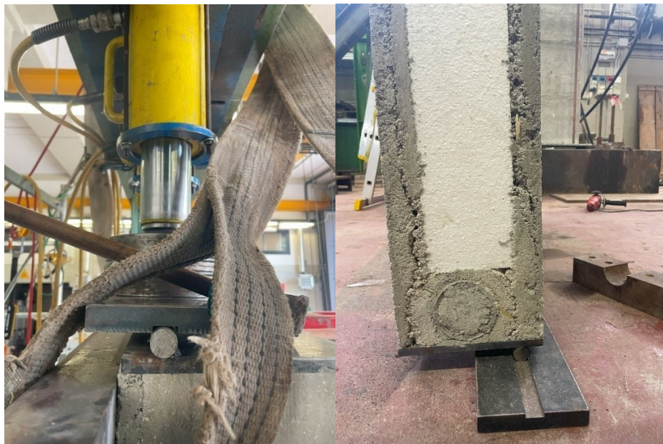
Figura 28 - Martinetti che applicano il carico sui dischi, che sono appoggiati sulla piastra (a), collegamento del pannello con la piastra d'acciaio saldata (b)
