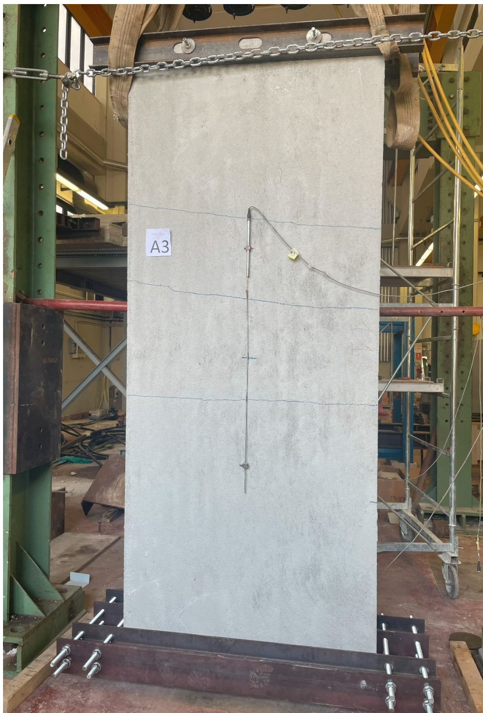
Figura 51 - Vista laterale delle lesioni per pressoflessione A3 (a), retro provino A3 (b), vista frontale della rottura per pressoflessione del provino A3 con le principali lesioni evidenziate
