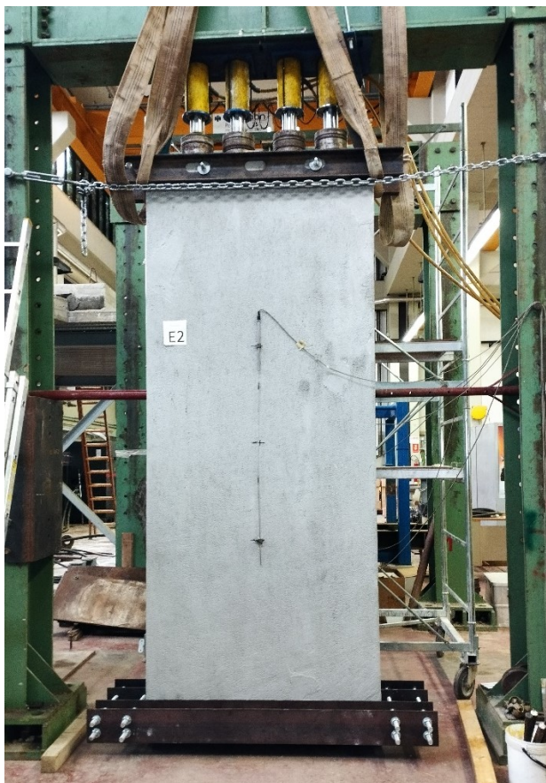
Figura 48 - Rottura per schiacciamento del cordolo superiore E2
