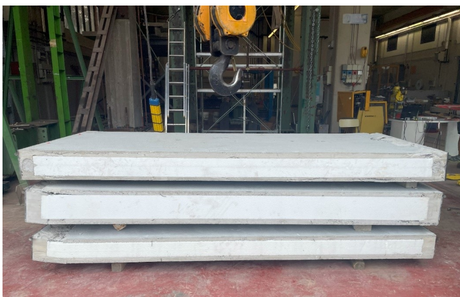
Figura 2 – Stratigrafia dei pannelli sandwich testati in laboratorio prodotti dalla ditta Due Emme
