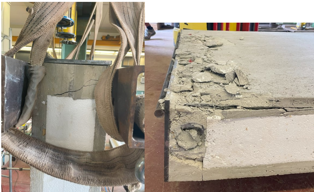
Figura 46 - Rottura per schiacciamento del cordolo superiore A2
