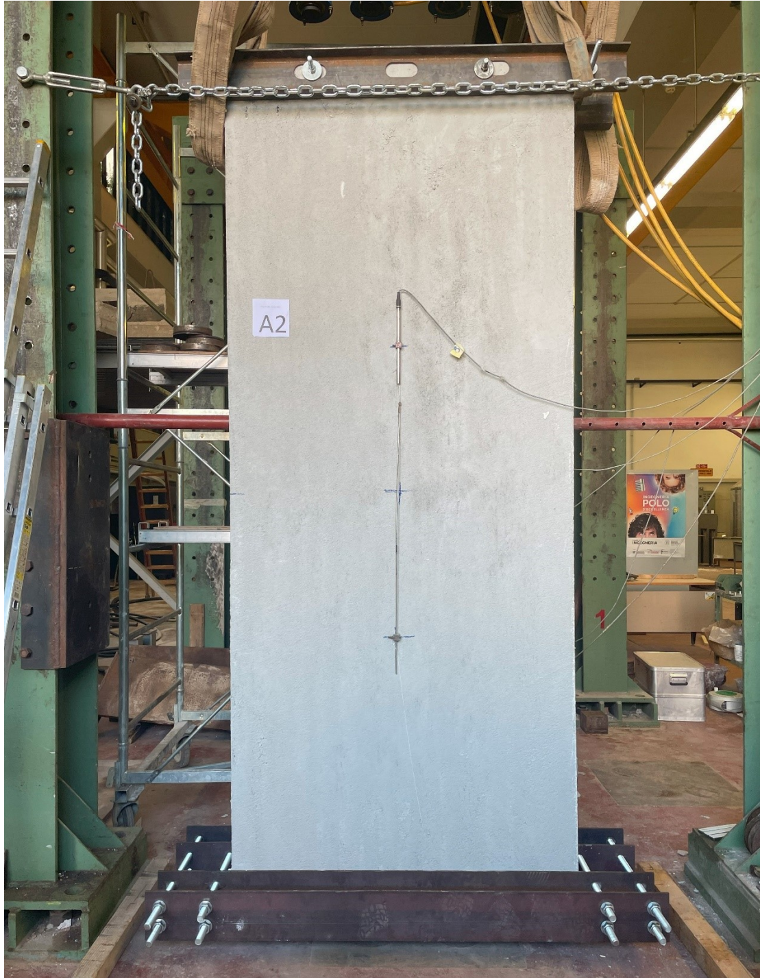
Figura 33 - Setup della prova con i profilati metallici
