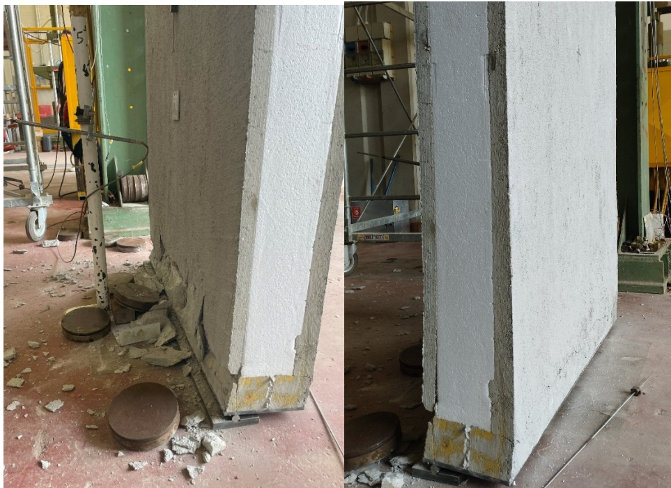
Figura 43 – Rottura per schiacciamento del cordolo inferiore del provino A1
