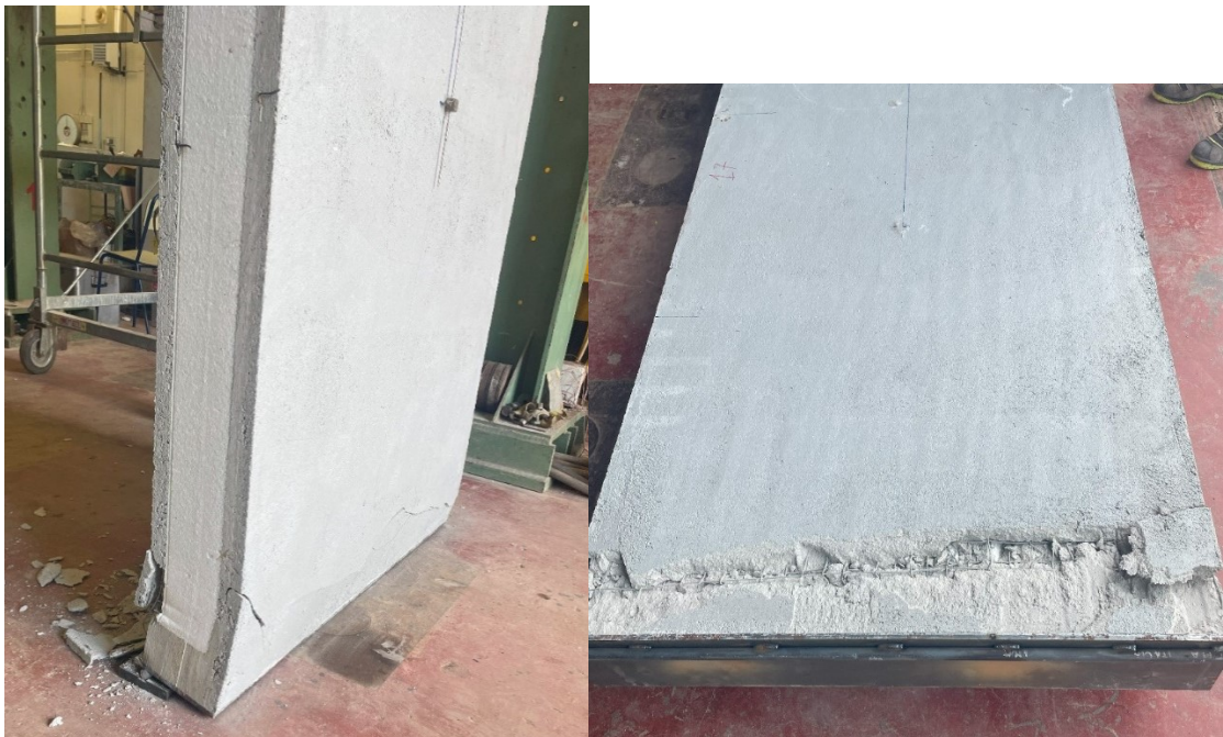
Figura 44 - Rottura per schiacciamento del cordolo inferiore F1
