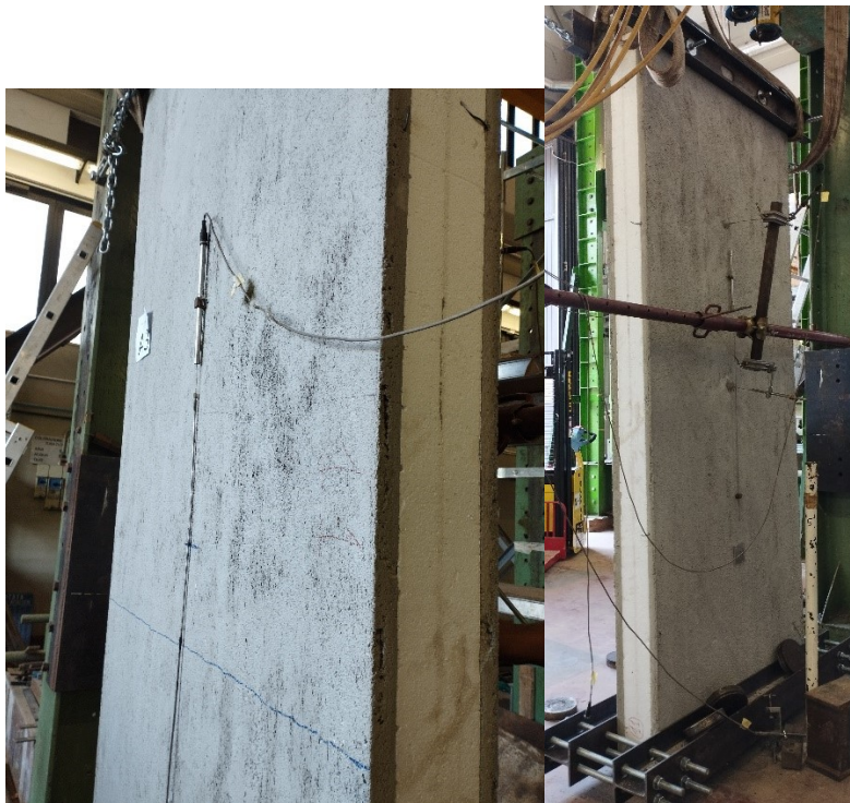
Figura 50 - Rottura per schiacciamento del cordolo superiore F3
