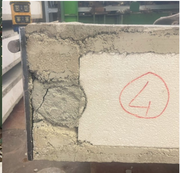
Figura 47 - Rottura per schiacciamento del cordolo superiore F2
