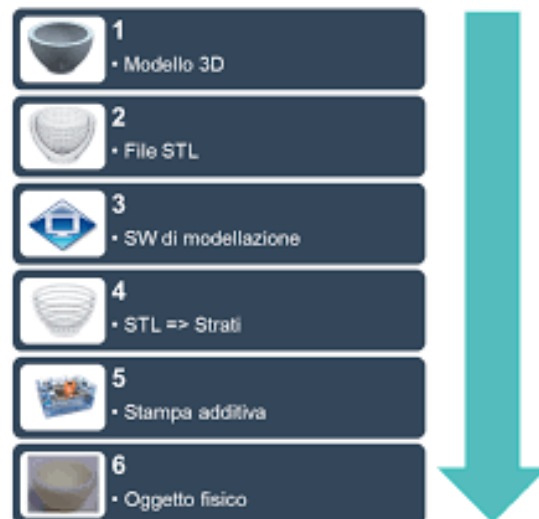
Fig. 4.2 Processo di AM [26]
