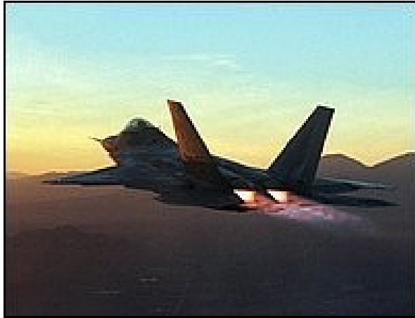
Fig. 3.8 F-22 con telaio al 42% in lega di titanio [16]
