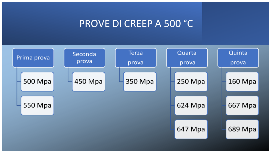
Fig. 5.1 Prove di creep svolte a 500^{\circ}\text{C} Fonte: rielaborazione personale
