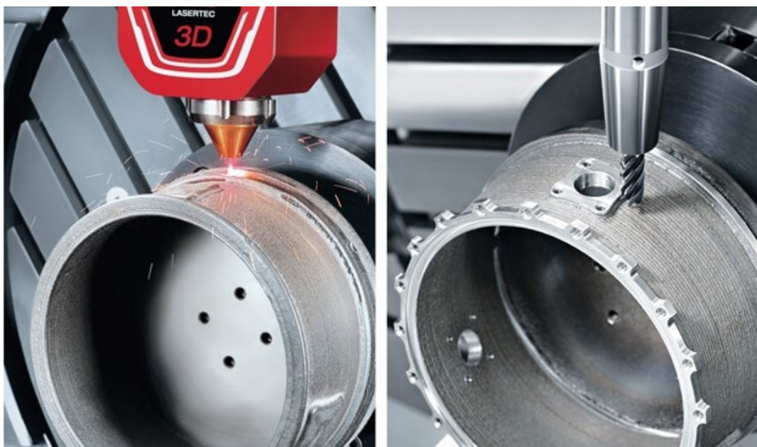
Fig. 4.11 Combinazione di DED e fresatura CNC (macchine a controllo numerico) [39]
