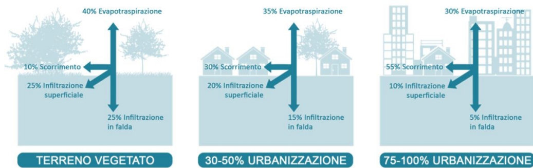
Figura 1.4 Impatto dell'impermeabilizzazione dei suoli sul ciclo idrologico
