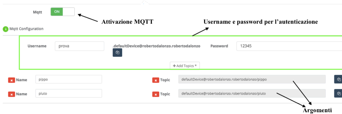
Figura 16: Inserimento credenziali e argomenti MQTT nel pannello di controllo di Altair, relativi al dispositivo di default registrato.
