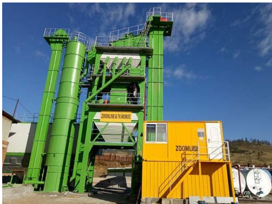
Figura 17: Torre di miscelazione
