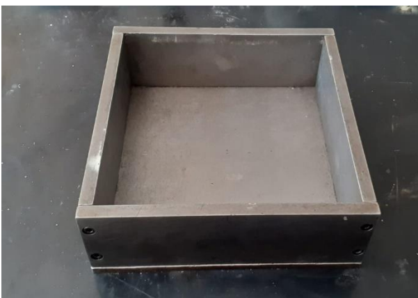
Figura 50, 51: Cassero in acciaio 30x30 cm; Compattatore meccanico
