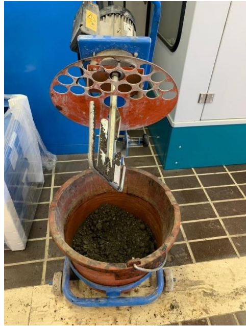
Figura 48, 49: Impasto miscelato con emulsione; Prodotto terminato e pronto alla compattazione
