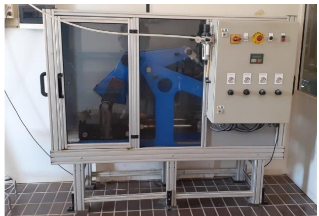
Figura 50, 51: Cassero in acciaio 30x30 cm; Compattatore meccanico
