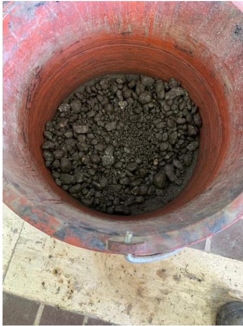
Figura 48, 49: Impasto miscelato con emulsione; Prodotto terminato e pronto alla compattazione
