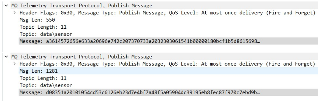
Figura 5.1: Cattura Wireshark di pacchetto a) non cifrato e b) cifrato.
