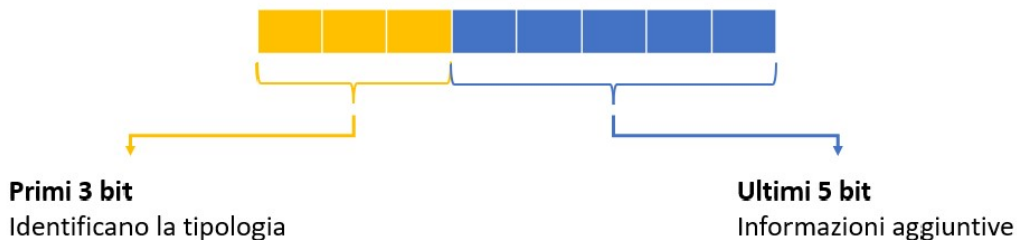
Figura 2.4: Header di un elemento CBOR.
