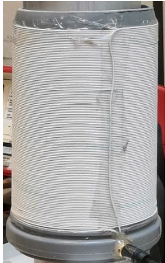
Figura 5 - Prototipo sensore di prossimità utilizzato
