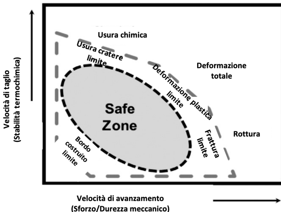
Figura 4 - Un diagramma della modalità di errore per un materiale utensile che incorpora un determinato materiale del pezzo e che mappa i meccanismi di usura come funzioni delle variabili di taglio dei metalli. La zona sicura definisce la regione operativa in cui lo strumento sopravvive in condizioni di usura prevedibili. [4]
