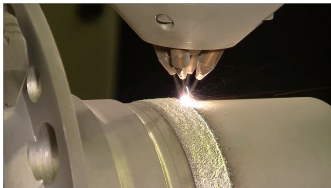
Figura 24 – Fusione di flusso di polvere per mezzo di laser multipli.
