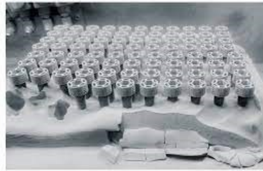
Figura 23 – “Grappolo” di elementi realizzati in serie tramite binder jetting.
