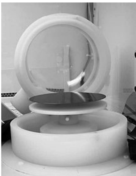
Figura 18 – a) Distributore centrifugo di materiale fotoresistente; b) Fotomaschere.
