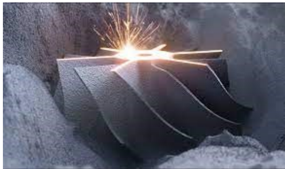
Figura 25 – Fusione su letto di polvere tramite SLM.
