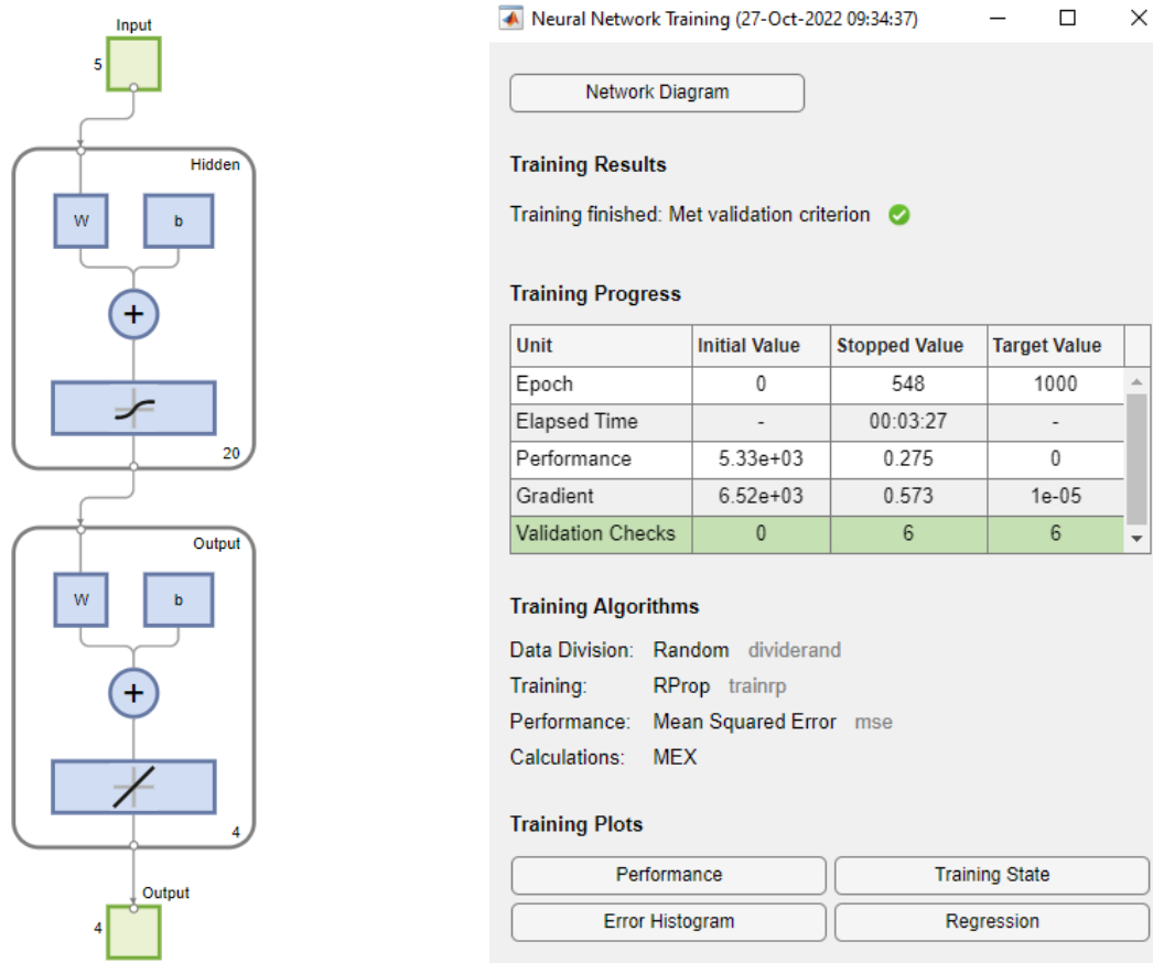
Figura 40 – a) Schema MLP realizzato; b) Monitor delle caratteristiche e dell'avanzamento del training della rete implementata.
