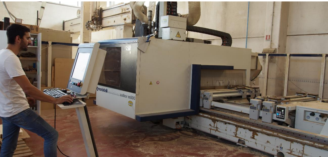
Figura 11 – Pantografo a 5 assi Morbidelli utilizzato dal responsabile tecnico Leonardo Innocenzi
