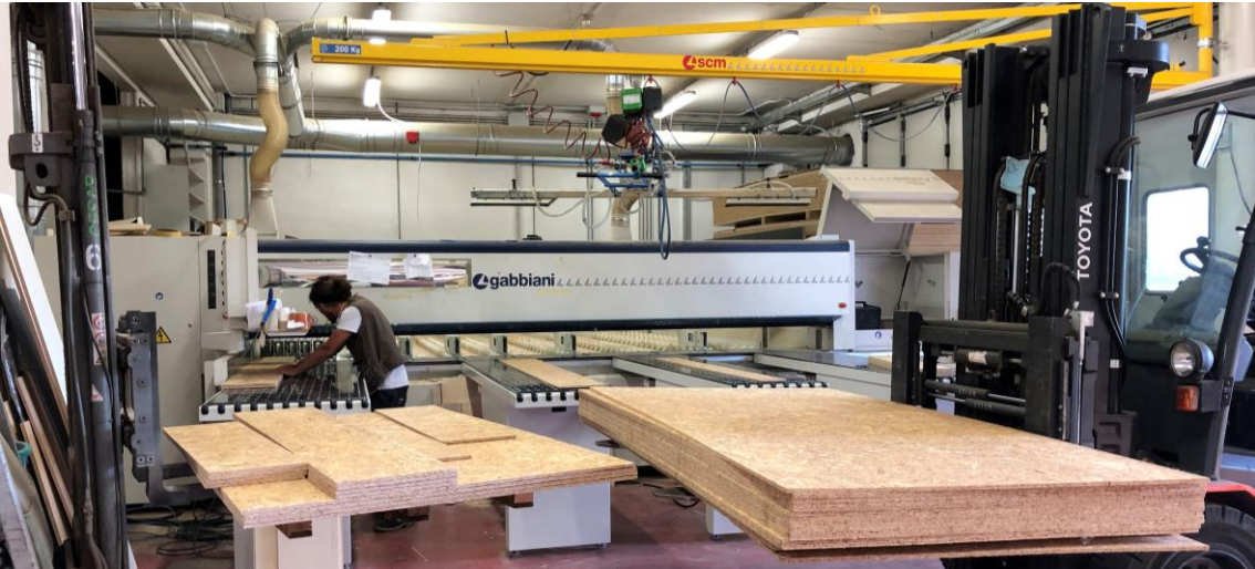
Figura 10 – Sezionatrice GABBIANI a carico frontale
