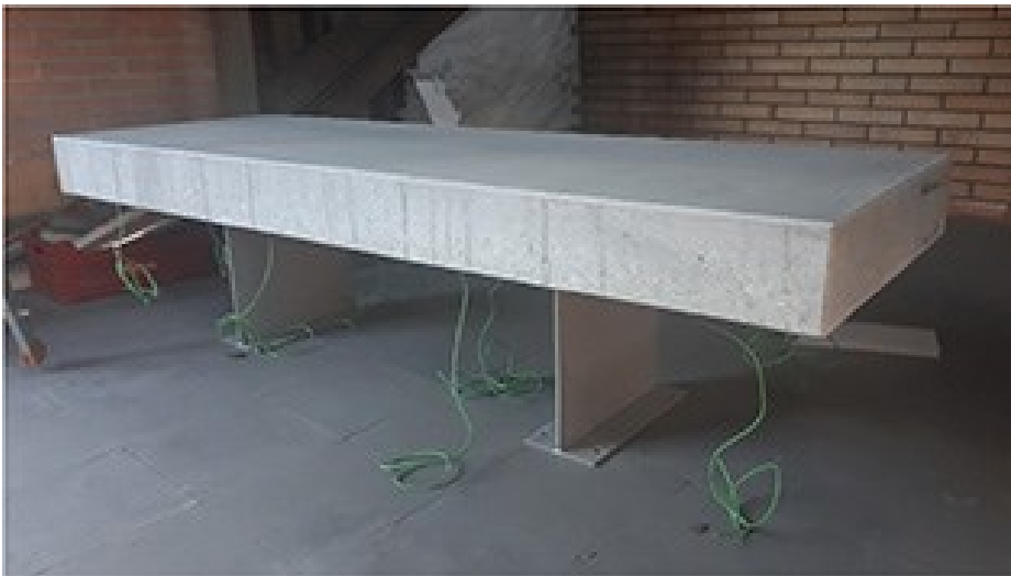
Figura 8. Aspetto visivo delle lastre a grandezza naturale realizzate per la caratterizzazione termica.
