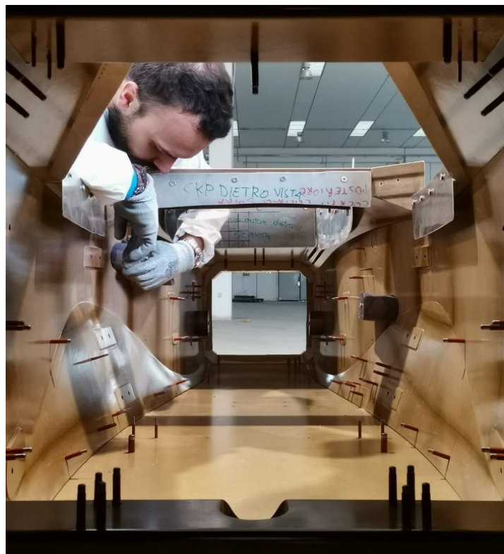
Figura 121 - Chiusura stampo per verifica assieme
