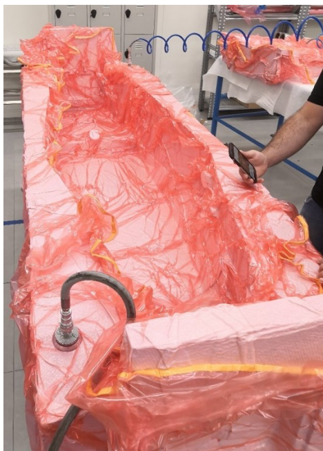
Figura 137 - Compattazione prima pelle
