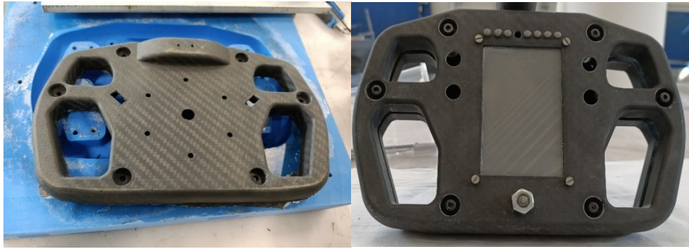
Figura 171 - Volante in composito per la P4 Evoluzione
