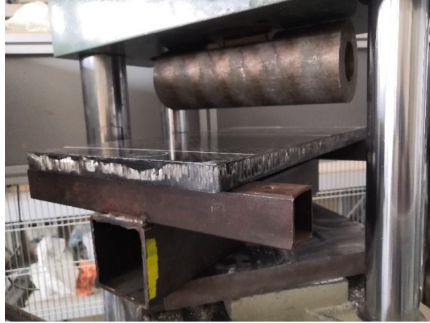
Figura 4 - Setup di prova per test di flessione a 3 punti.
