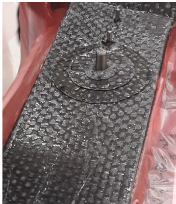
Figura 124 - Esempio di patch di rinforzo
