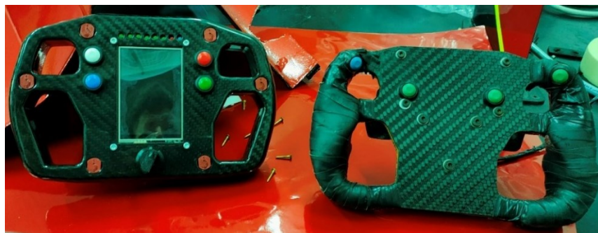
Figura 172 - Confronto tra volante P4M e P4 Evoluzione
