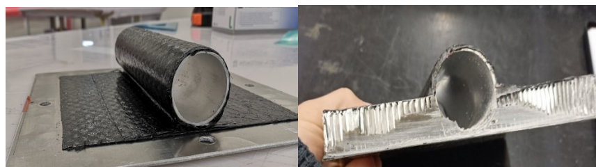
Figura 166 - Tecnica di lamianzione front hoop
