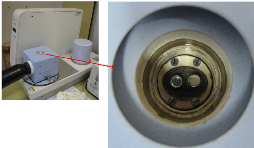
Figura 61 - Macchina per analisi DSC [2]
