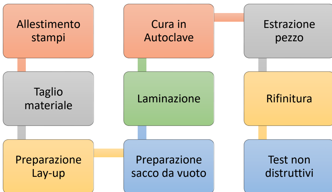
Figura 40 - Processo produttivo mediante ciclo in autoclave
