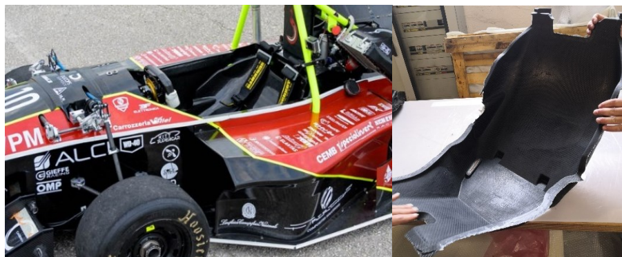
Figura 175 - Aggiunta di un nuovo sedile più ergonomico
