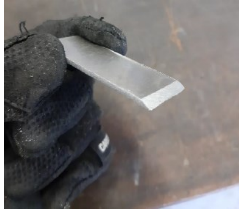
Figura 74 - Tab irruvidito e con smusso a 45°
