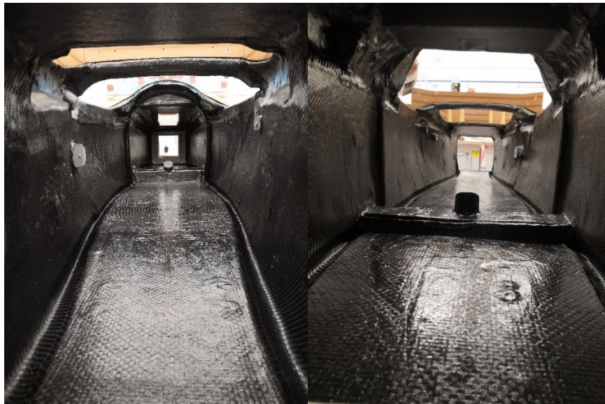
Figura 150 - Termine della laminazione
