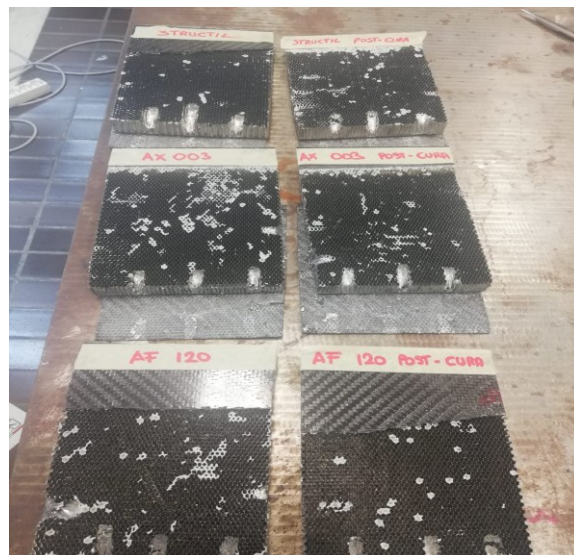
Figura 44 - "Peel Test" dei diversi tipi di adesivi
