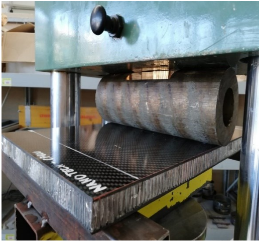
Figura 57 - Test flessione a 3 punti
