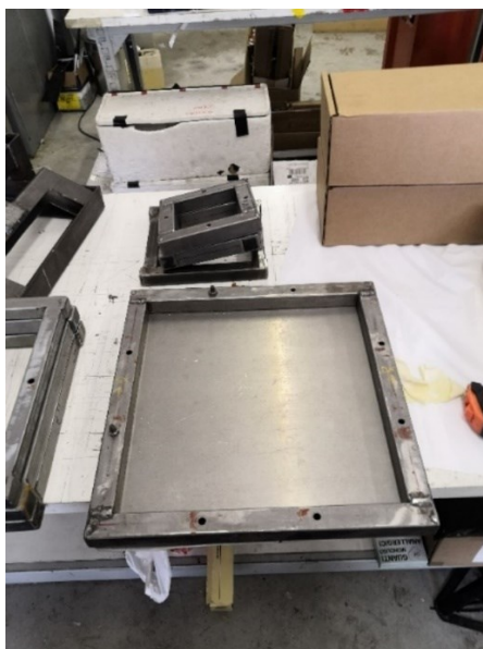
Figura 98 - Materiale di supporto per la laminazione dei pannelli
