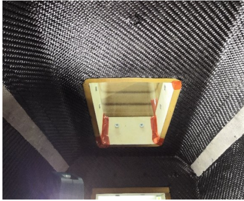
Figura 147 - Giunzione stampi telaio P4M
