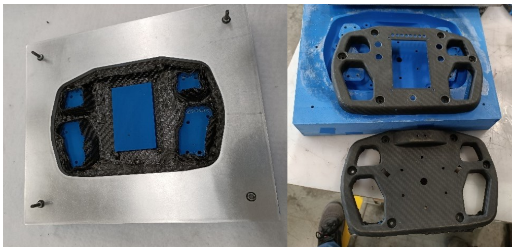
Figura 170 - Riprogettazione del volante in composito
