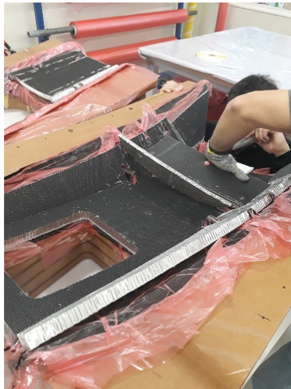
Figura 140 - Laminazione semistampo anteriore
