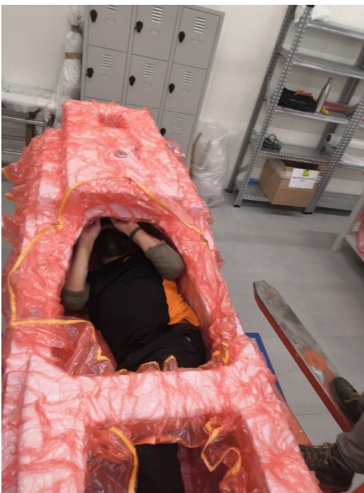
Figura 152 - Preparazione sacco da vuoto per cura in autoclave
