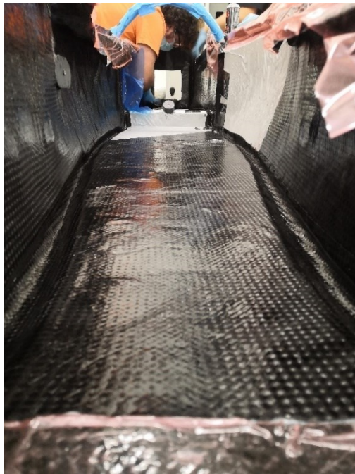
Figura 144 - Deposizione seconda pelle
