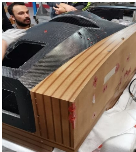
Figura 156 - Estrazione telaio da stampi
