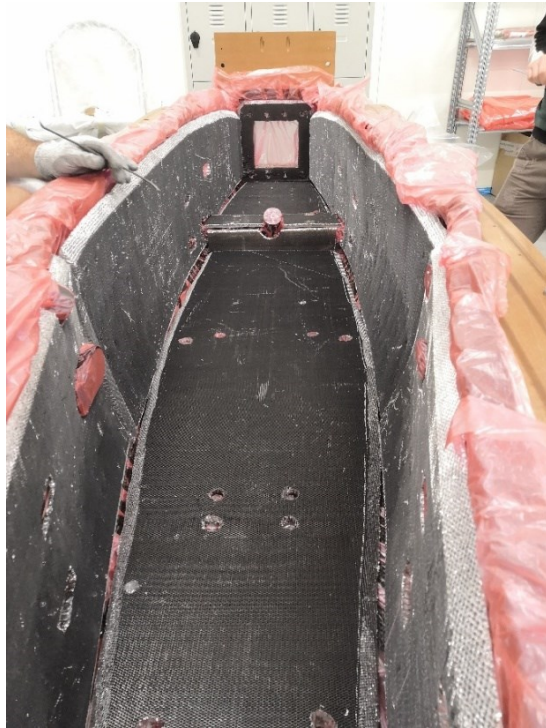
Figura 141 - Taglio e rifila del core
