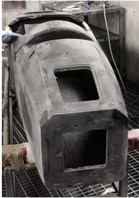
Figura 159 - Carteggiatura telaio epr rifinimento estetico
