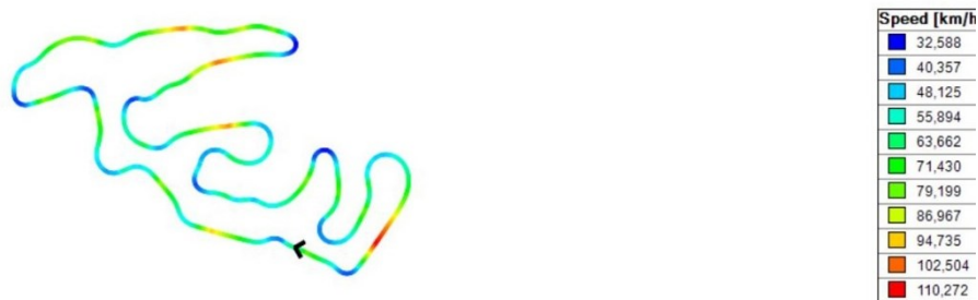
Figura 182 - Simulazione performance su tracciato FSG
