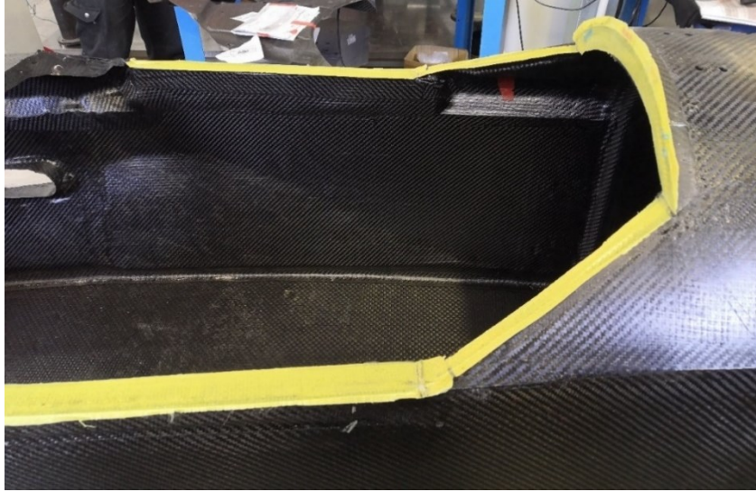
Figura 157 - Aspetto del telaio dopo la cura
