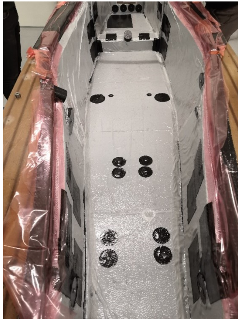
Figura 143 - Deposizione core e film adesivo
