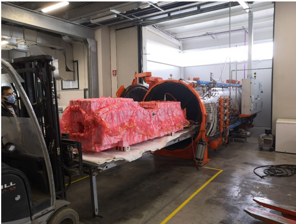
Figura 154 - Posizionamento stampi in autoclave
