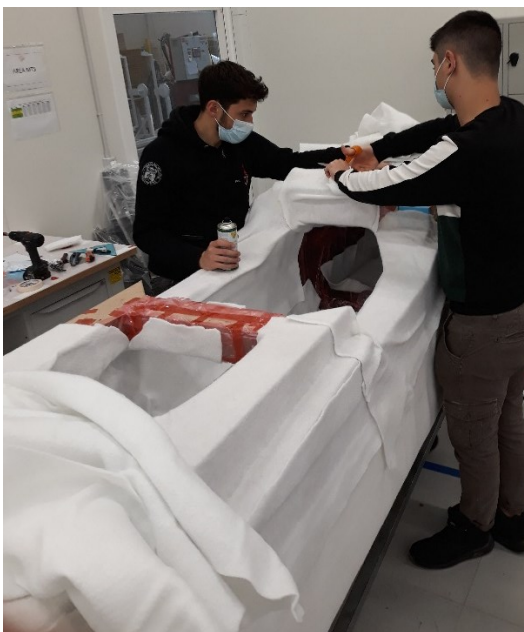
Figura 151 - Preparazione per sacco da vuoto
