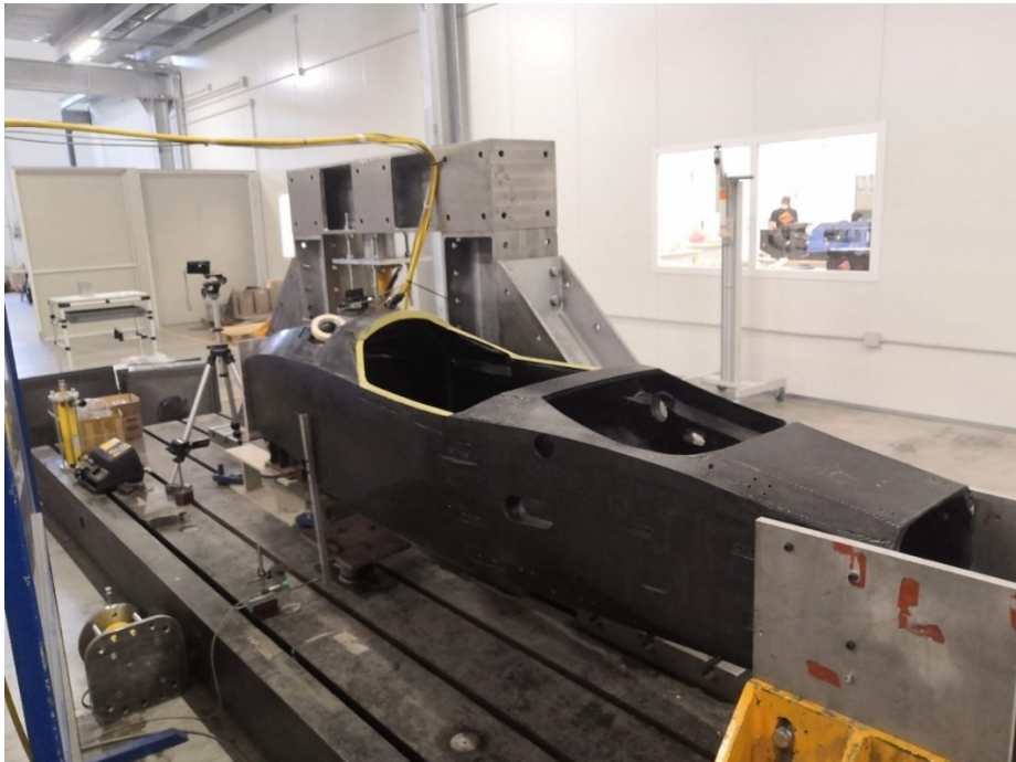
Figura 160 - Test rigidità torsionale telaio P4 Evoluzione
