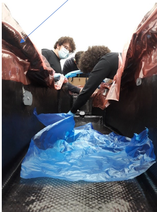
Figura 145 - Termine laminazione vasca inferiore
