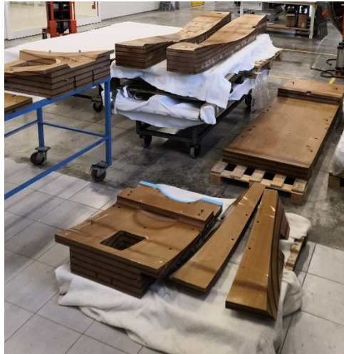
Figura 119 - Stampo scomposto per fase iniziale della produzione
