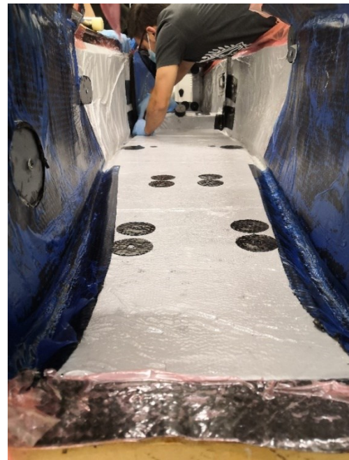
Figura 144 - Deposizione seconda pelle
