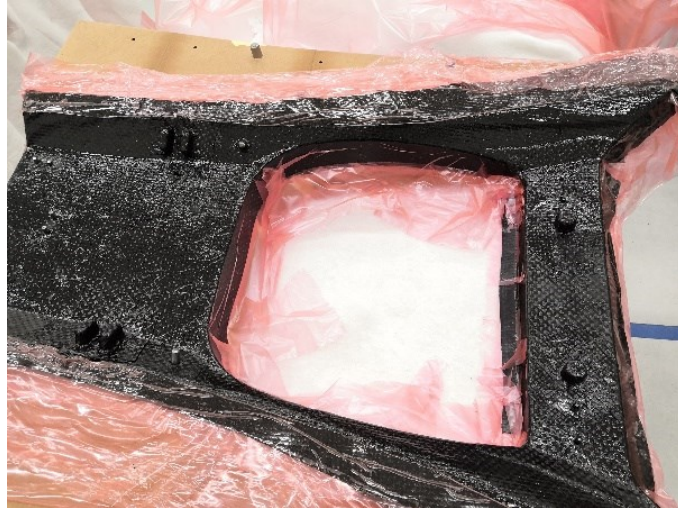
Figura 139 - Laminazione semistampo posteriore
