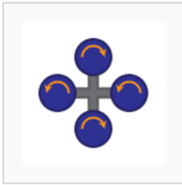
(a) Il drone varia l'altitudine variando la spinta di ogni singolo motore in egual misura
