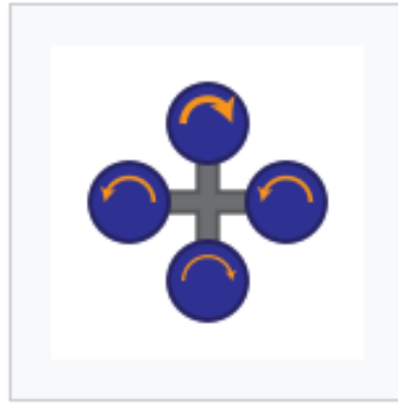
(b) Il beccheggio varia applicando più spinta ad un singolo motore e diminuendo quella del motore diametralmente opposto
