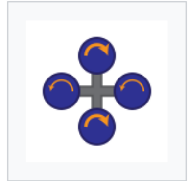
(c) L'imbardata varia modificando la velocità di una coppia di motori diametralmente opposti
