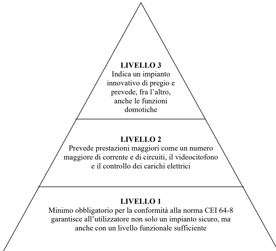
Figura I.2: livelli prestazionali impianto elettrico Fonte: elaborazione dell'autore
