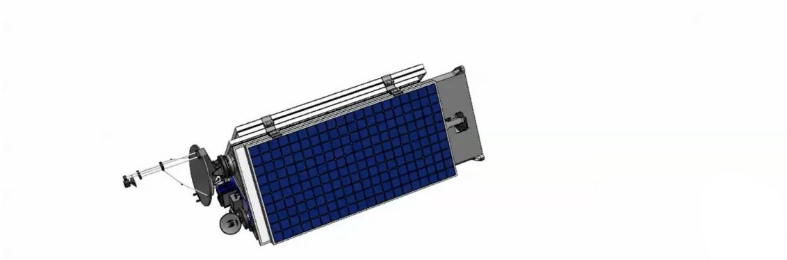
Figura 3.4: Prima configurazione: pannelli solari chiusi [8]
