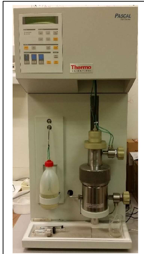
Figura 46: Porosimetro a mercurio
