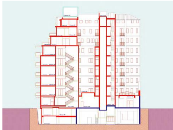
Figura 24, Sistemi di Compartimentazione
