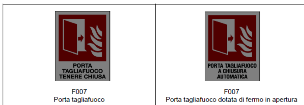
Figura 28, Segnaletica per porte tagliafuoco
