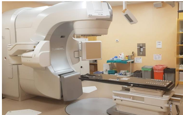
Figura 13. Linac Varian TrueBeam™ STx.
