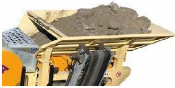
Figura 7 Tramoggia di carico in Hardox
