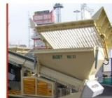
**Tramoglia di carico con griglia vibrante e con possibilità di sollevamento idraulico.**
