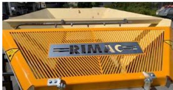
Figura 8 Sistema di nebulizzazione a tre zone comprensivo di serbatoio acqua a bordo macchina.
