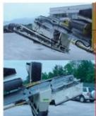
**Sistema di collegamento rapido** che permette il funzionamento idraulico del sistema di vagliatura (VAI CONN, VALTRACK, ecc.).
