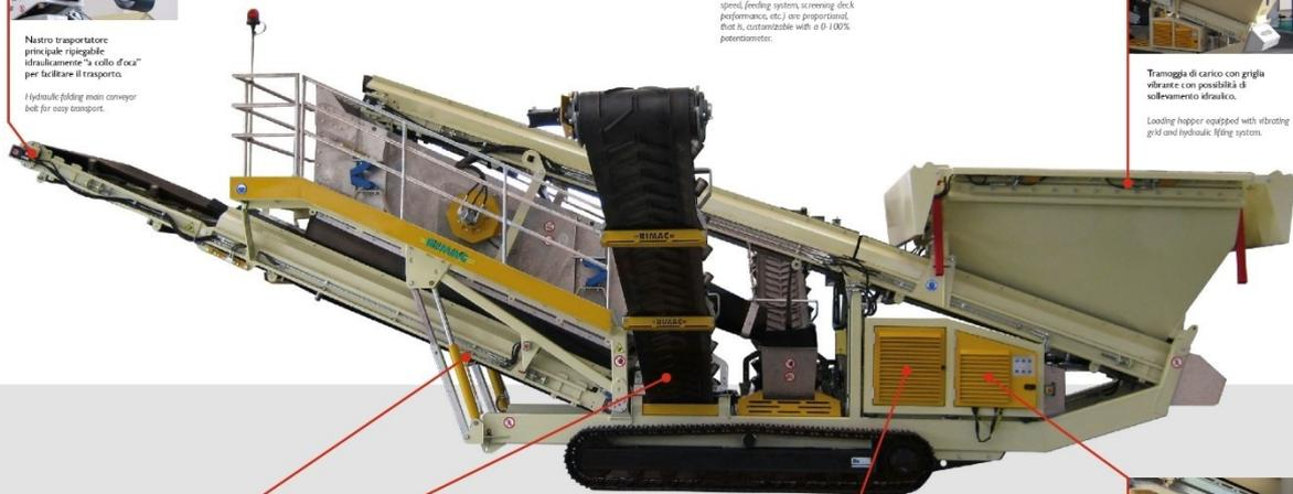
**Piano vagliante inclinabile idraulicamente per ottimizzare le operazioni di vagliatura e permettere la messa in sagoma per le fasi di trasporto.**
