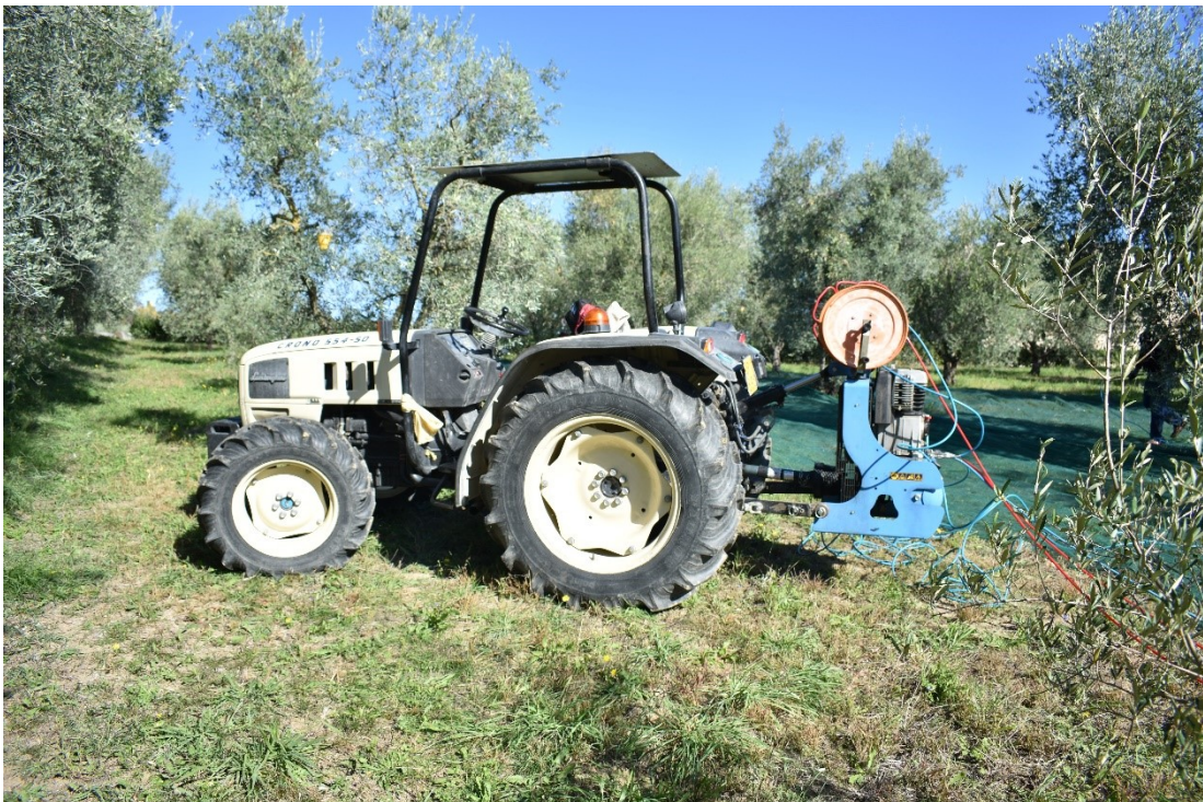
Figura 23- “Compressore con attacco a tre punti e azionato dalla presa di potenza della trattrice”.
