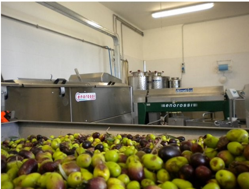
Figura 16- “Frantoio aziendale con sistema continuo a due fasi”.
