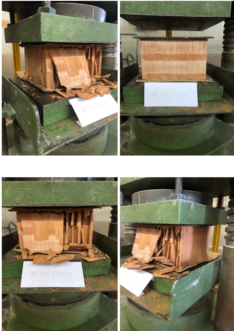
Figura 4.2 Prove di compressione su POROTON
