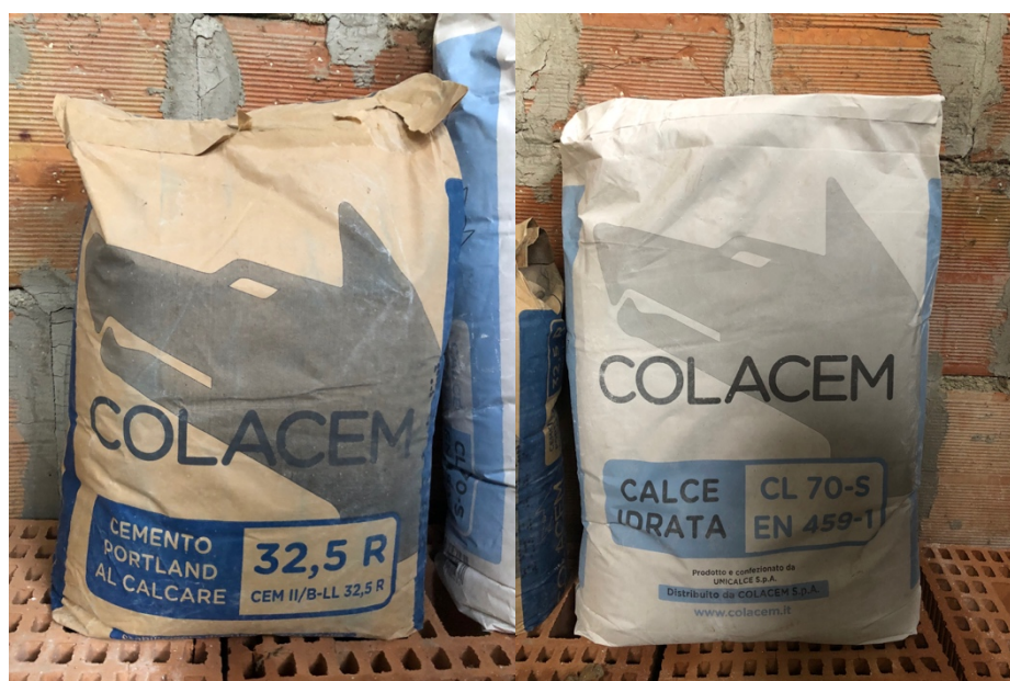
Figura 4.1 Calce idrata e cemento Portland composito 32.5 R
