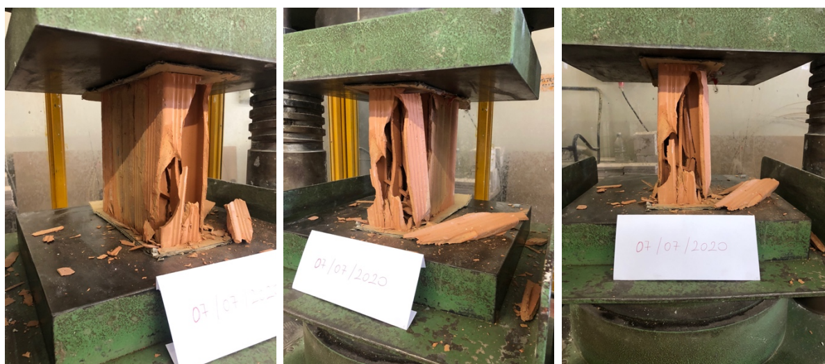
Figura 4.3 Prove di compressione su FORATO da 8 cm
