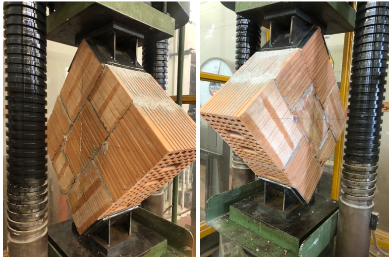
Figura 4.12 Lato 1 e Lato 2 prima (sopra) e dopo (sotto) la prova
