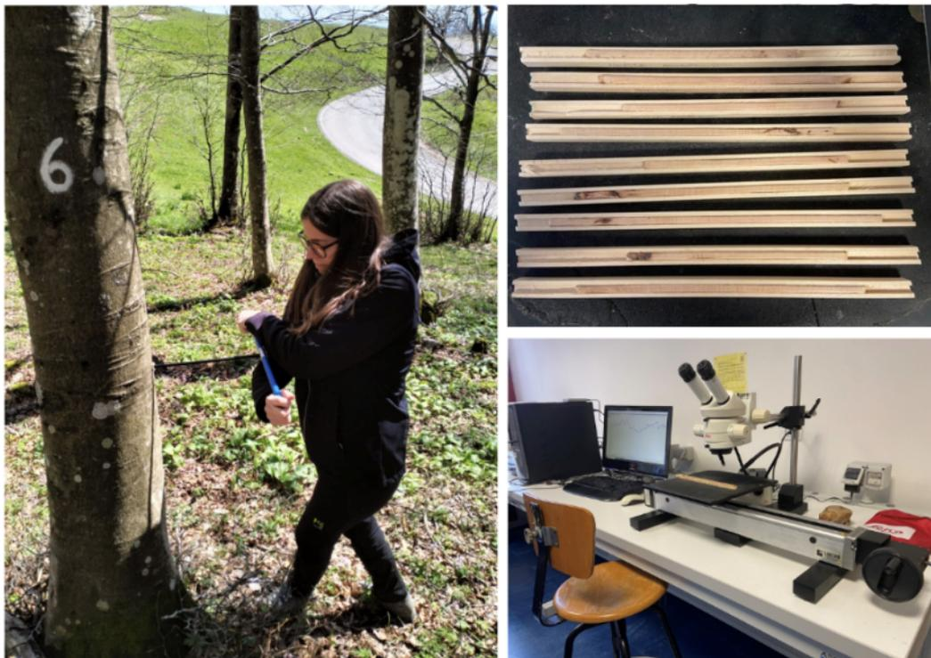
Figura 2.2.3.1: sx, carotaggio con succhiello di Pressler, dx in alto, esempio di campioni legnosi, dx in basso, stazione laboratorio con misuratore semiautomatico LINTAB
