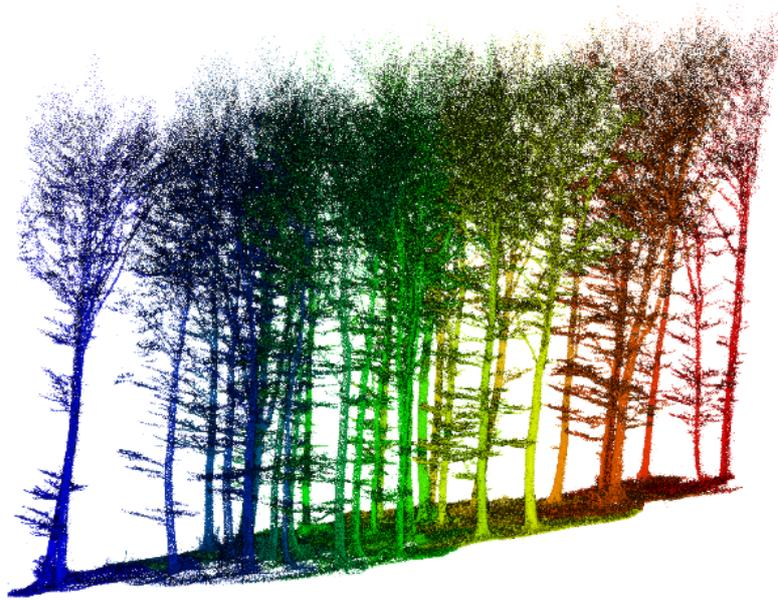
Figura 2.2.2.2: restituzione del rilievo fatto con mobile laser scanner da cui è possibile estrarre le altezze.
