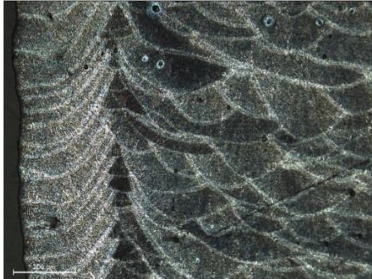
Fig. 17 - Morfologia dei Campioni AlSi10Mg As Deposited, con relativo cordone e pozze fuse
